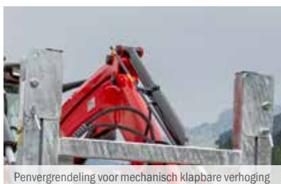
Penvergrendeling voor mechanisch klapbare verhoging
