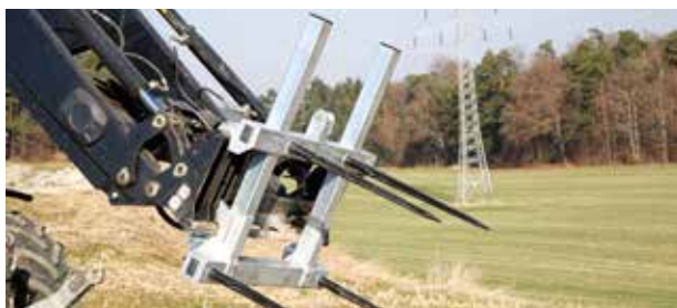
Uitvoering met verhoging met 4 rondebalentanden (2 tanden standaard)
