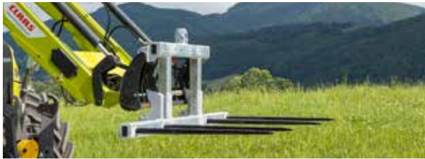
Standaarduitvoering met 4 rondebalemtanden (standaard)
