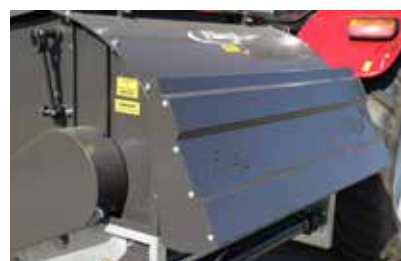
Hydraulisch dekseel – beste bescherming tegen verwondingen
