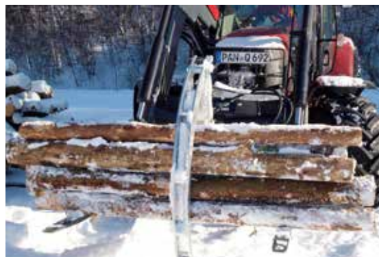
Hydraulische grijparm aan de combipalletvork »Freisicht« bevestigd
