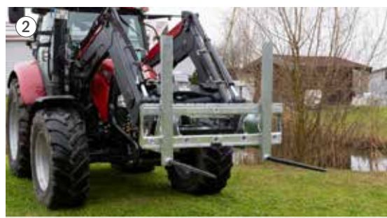
Verstelbare opname voor rondebalemtanden M 28 x 1,5 mm
