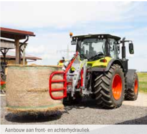
Aanbouw aan front- en achterhydrauliek
