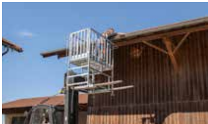
Aanbouw aan de stapelaar met kettingbeveiliging
