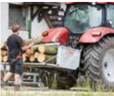
Uitklapbare pendelwand dient als bakverlenging
