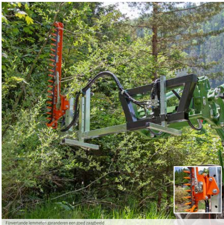
Fijnvertande lemmeten garanderen een goed zaagbeeld
