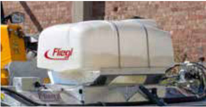
Tank 300 l voor de sproei-inrichting
