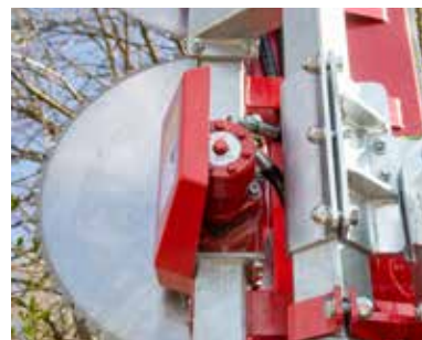
Aandrijving van de zaagbladen met oliemotoren
