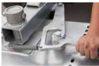
Mechanische zwenkbok (30°), optioneel met hydraulische zwenkbok
