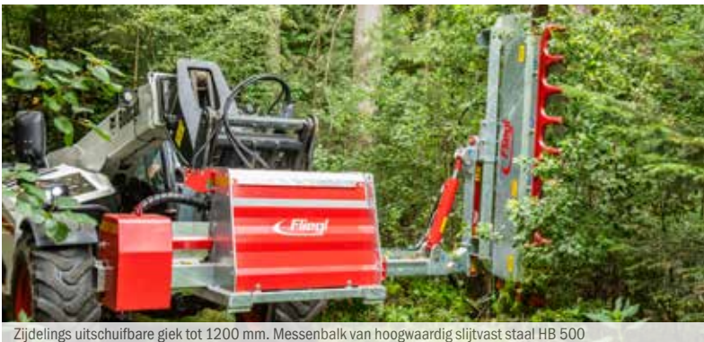
Zijdelings uitschuifbare giek tot 1200 mm. Messenbalk van hoogwaardig slijtvast staal HB 500
