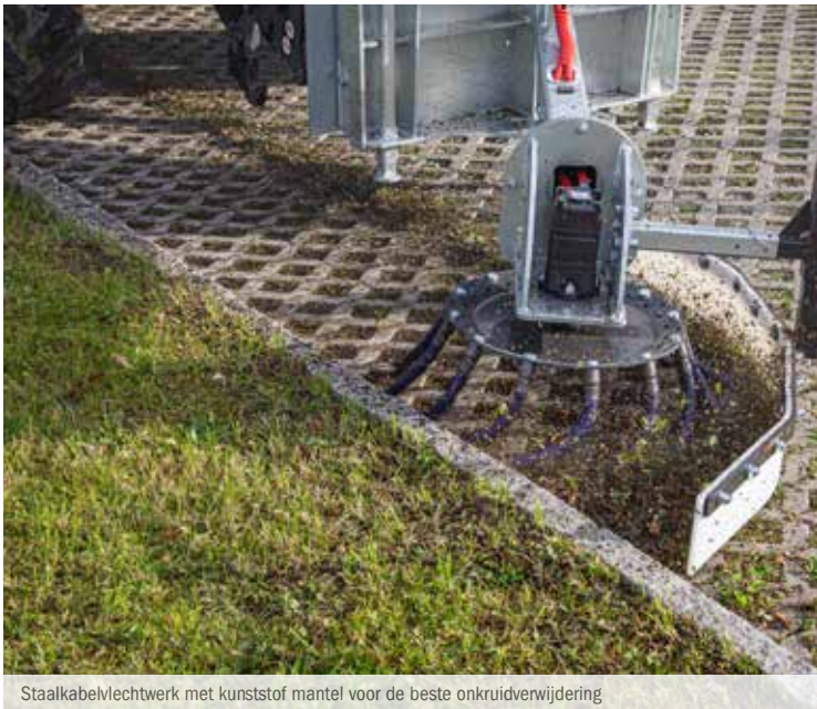
Staaakabelvlechtwerk met kunststof mantel voor de beste onkruidverwijdering
