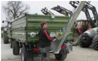
Eenvoudige verstelling van de verdeelhoek
