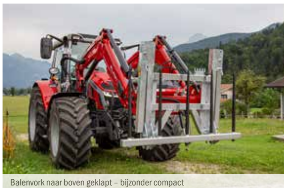
Balenvork naar boven geklapt – bijzonder compact
