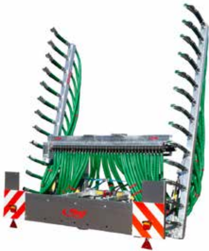
Transportbescherming met verlichting en waarschuwingsborden (standaard)
