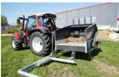
Hydraulische aanpassing van de van de opnamearm
