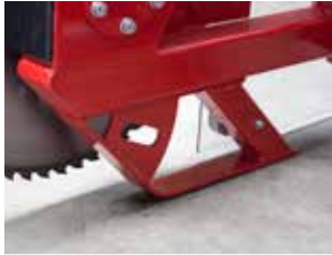
Beschermbeugel voorkomt bodemcontact van het onderste zaagblad.
