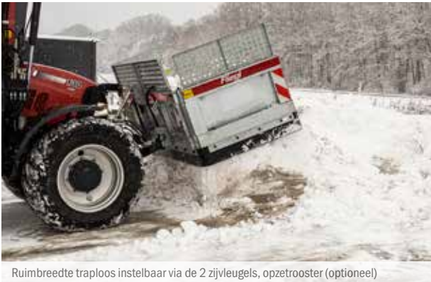
Ruimbreedte traploos instelbaar via de 2 zijvleugels, opzetrooster (optioneel)
