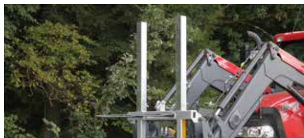
Opsteekbuizen voor balenvork »Combi« met verhoging
