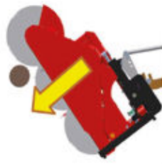
Aanwijzing: Snoei dikke takken altijd van boven naar onder om het klemmen van de zaagbladen te voorkomen!
