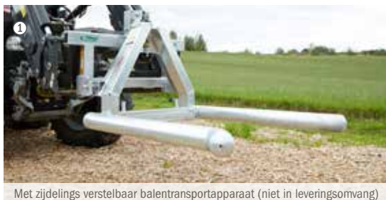
Met zijdelings verstelbaar balentransportapparaat (niet in leveringsomvang)
