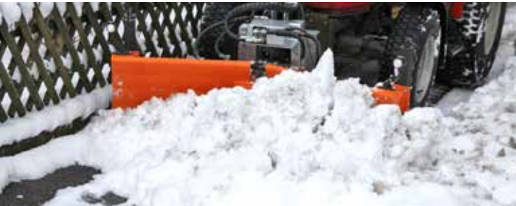
2 hydraulisch zwenkbare vleugels met afzonderlijke aansturing
