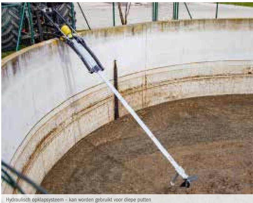
Hydraulisch opklapsysteem – kan worden gebruikt voor diepe putten
