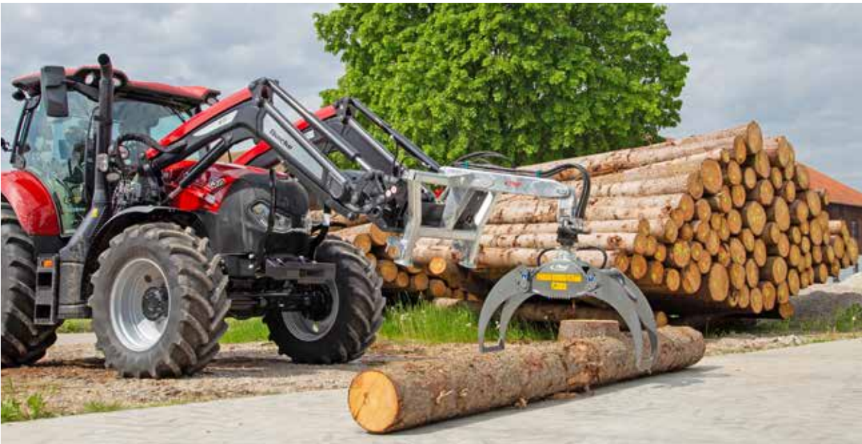
Overlaadgrijper met lasthaakverlenging, draaimotor, Euronorm- en driepuntsopname
