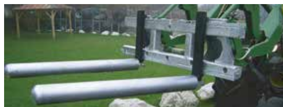
Opsteekbuizen voor rondebaletransport vastgezet met schroeven
