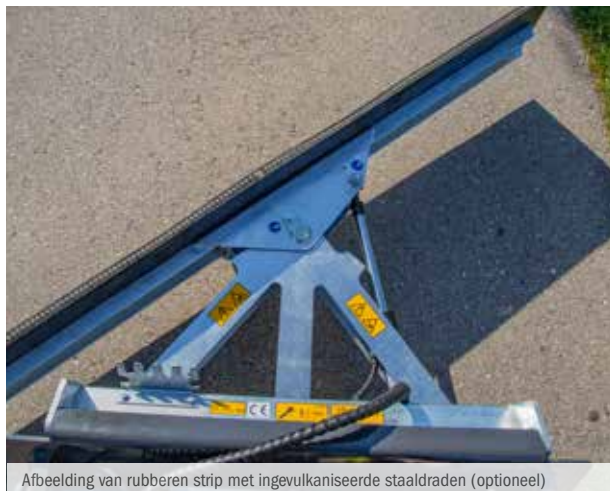
Afbeelding van rubberen strip met ingevulkaniseerde staaldraden (optioneel)
