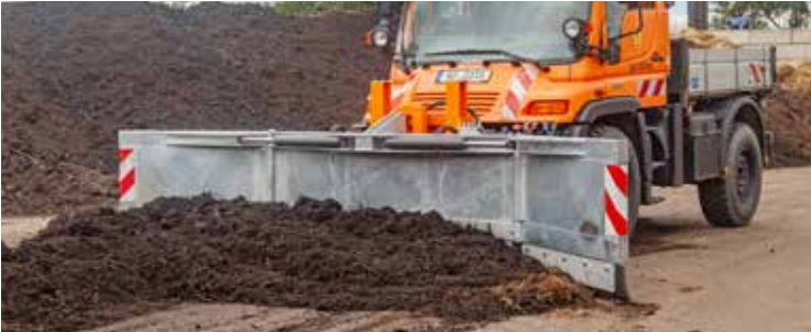
Met rubberstrips, duurzaam dankzij ingegoten staalkabels
