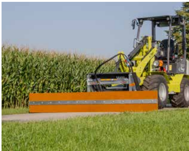
Afbeelding van rubberen strip met ingevulkaniseerde staaldraden (optioneel)
