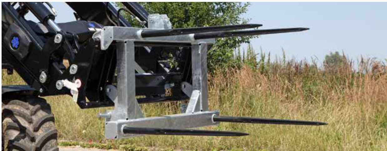
Standaarduitvoering, hier met 4 rondebalentanden (2 tanden standaard)
