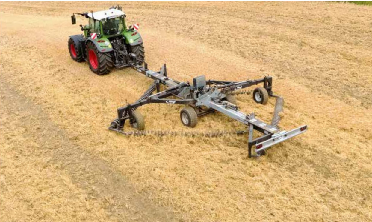
Zware kettingen met instelbare bewerkingsagressiviteit van 51° tot 58
