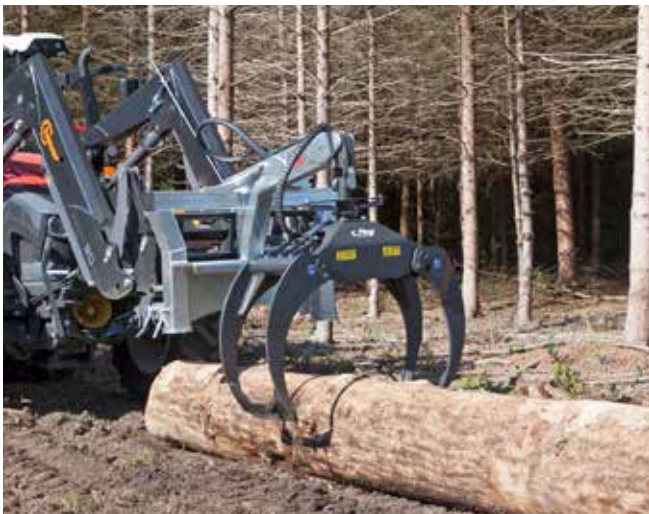
Hydraulische houtgrijper »RZ 185 Combi« met mechanisch draaischarnier
