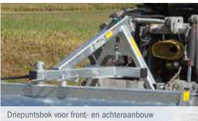
Driepuntsbok voor front- en achteraanbouw
