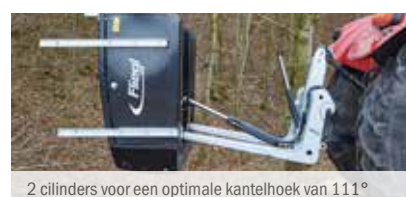
2 cilinders voor een optimale kanteelhoek van 111°
