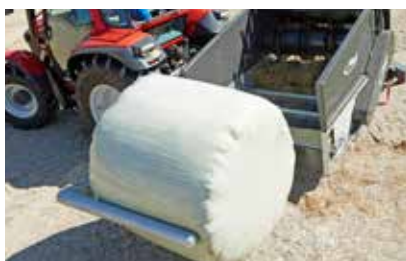
Hydraulisch verstelbare opnamearm
