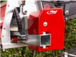
Het zijdelingse contragewicht helpt de eenzijdige belasting op de zwenkarm van het draagvoertuig te verminderen
