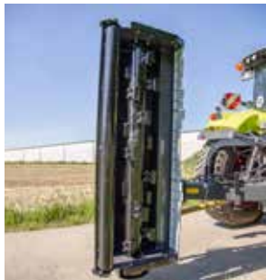
Extreem slijtvaste hamerklepel
