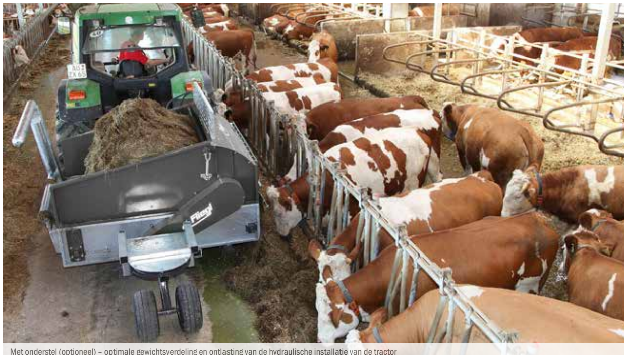
Met onderstel (optioneel) – optimale gewichtsverdeling en ontlasting van de hydraulische installatie van de tractor
