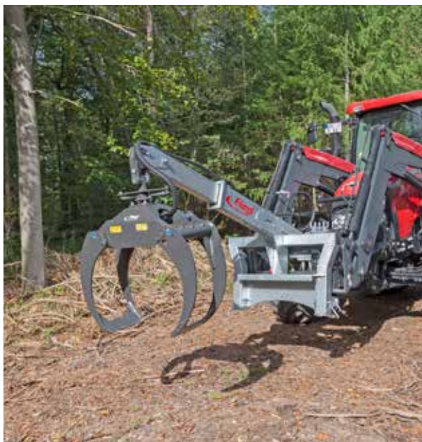
Hydraulische houtgrijper »LongNeck Combi« met mechanisch draaischarnier
