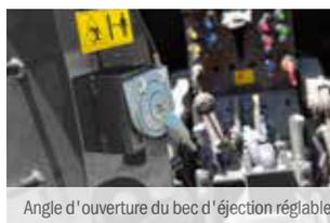
Angle d'ouverture du bec d'éjection réglable
