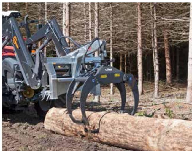
Grappin « RZ 185 Combi » hydraulique avec articulation mécanique
