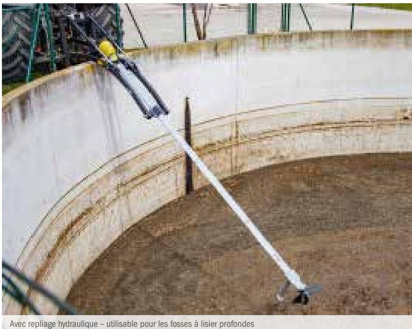
Avec repliage hydraulique - utilisable pour les fosses à lisier profondes
