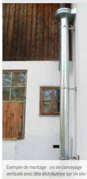
Exemple de montage : vis de convoyage verticale avec tête distributrice sur un silo
