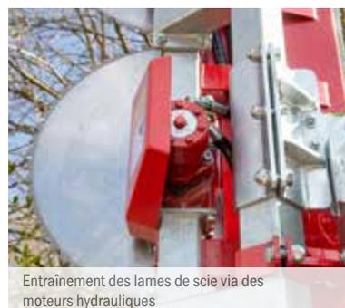
Entraînement des lames de scie via des moteurs hydrauliques
