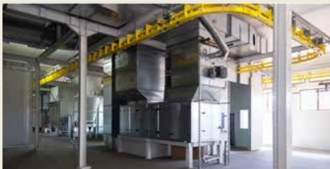
Nous posons également des jalons en matière de durabilité chez Fliegl grâce à notre technologie de surface. Nous couvrons les processus de prétraitement, de peinture et de séchage, très gourmands en énergie, par nos propres processus de production à partir de panneaux solaires et de copeaux de bois, ainsi que par le chauffage urbain. Fliegl ne néglige pas non plus l'environnement.
