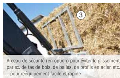
Arceau de sécurité (en option) pour éviter le glissement, par ex. de tas de bois, de balles, de profils en acier, etc. – pour rééquipement facile et rapide
