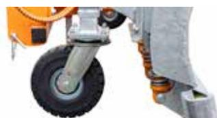
Roues porteuses pour lourdes charges en caoutchouc ultra-élastique : Ø 306 mm, largeur 105 mm, montées sur roulement à billes, bande de roulement résistante à l'abrasion, version avec couronne de rotation lourde, béquille réglable
