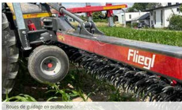
Roues de guidage en profondeur
