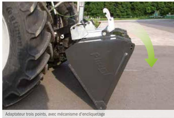
Adaptateur trois points, avec mécanisme d'encliquetage
