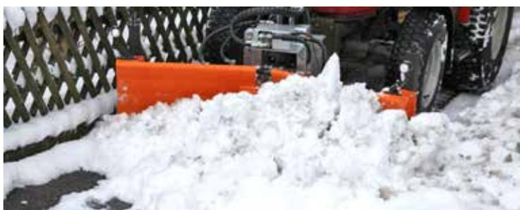
2 panneaux à orientation hydraulique avec commande séparée
