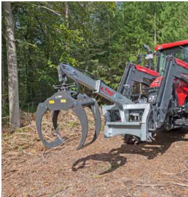
Grappin « LongNeck Combi » hydraulique avec articulation mécanique
