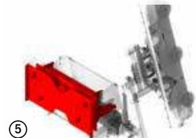
⑤ Limiteur de charge : si la pression d'appui est trop élevée, la tête s'incline vers l'arrière.
