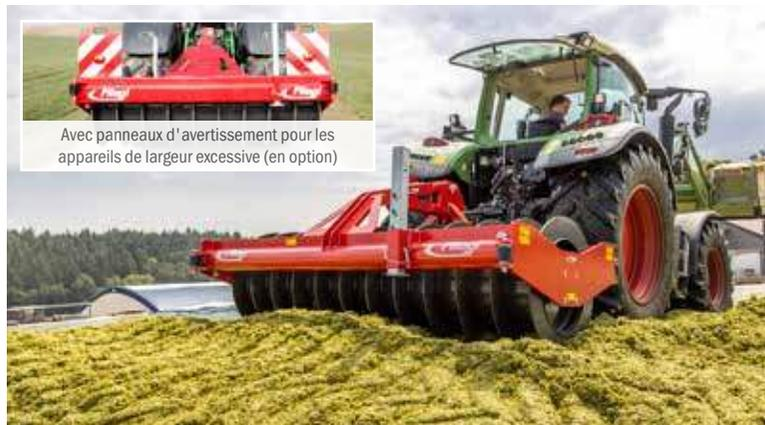
Avec panneaux d'avertissement pour les appareils de largeur excessive (en option)
