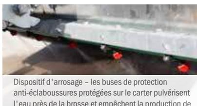
Dispositif d'arrosage – les buses de protection anti-éclaboussures protégées sur le carter pulvérisent l'eau près de la brosse et empêchent la production de poussière
