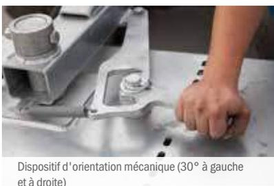
Dispositif d'orientation mécanique (30° à gauche et à droite)
