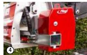
④ Contrepoids latéral – charge minimisée sur le bras oscillant du véhicule porteur.
