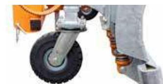
Roues porteuses pour lourdes charges en caoutchouc plein ultra-élastique : Ø 306 mm, largeur 105 mm, montées sur roulement à billes, bande de roulement résistante à l'abrasion, version avec couronne de rotation lourde, béquille réglable
