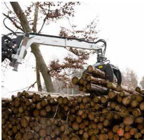
Grappin « LongNeck Combi-Plus » hydraulique avec rotateur
