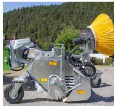
La brosse de balayage peut être réglée en continu à l'aide d'une béquille et utilisée jusqu'à la limite d'usure extrême
