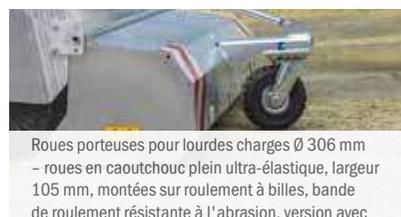
Roues porteuses pour lourdes charges Ø 306 mm – roues en caoutchouc plein ultra-élastique, largeur 105 mm, montées sur roulement à billes, bande de roulement résistante à l'abrasion, version avec couronne de rotation lourde
