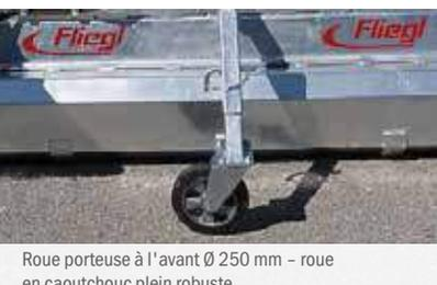
Roue porteuse à l'avant Ø 250 mm - roue en caoutchouc plein robuste
