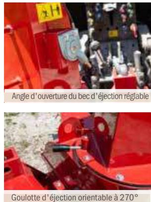
Angle d'ouverture du bec d'éjection réglable
