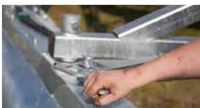
Dispositif d'orientation mécanique
