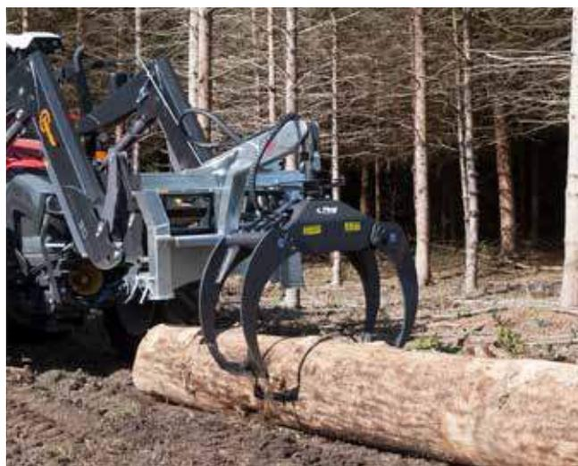
Grappin « RZ 185 Combi » hydraulique avec articulation mécanique
