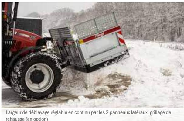
Largeur de déblayage réglable en continu par les 2 panneaux latéraux, grillage de rehausse (en option)
