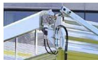
Entraînement hydraulique via moteur hydraulique – pour rentrer le filet
