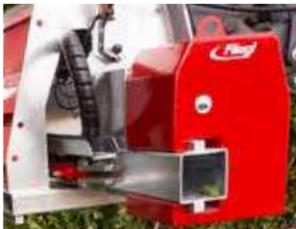
Contrepoids latéral - charge minimisée sur le bras oscillant du véhicule porteur.
