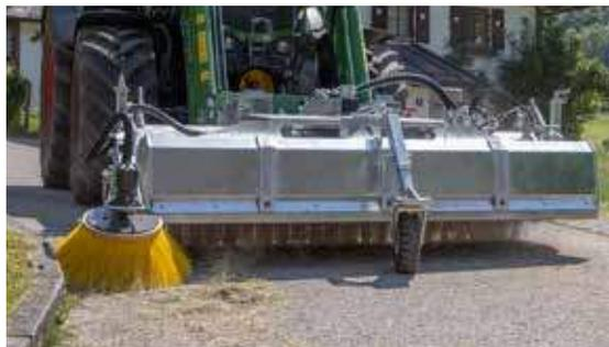
Ici en mode standby du balayage (balayage possible avec cuve de collecte des déchets ouverte en actionnant une vanne d'arrêt)
