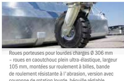
Roues porteuses pour lourdes charges Ø 306 mm - roues en caoutchouc plein ultra-élastique, largeur 105 mm, montées sur roulement à billes, bande de roulement résistante à l'abrasion, version avec couronne de rotation lourde, béquille réglable
