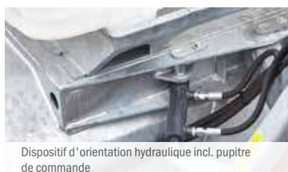
Dispositif d'orientation hydraulique incl. pupitre de commande
