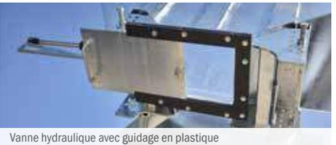
Vanne hydraulique avec guidage en plastique
