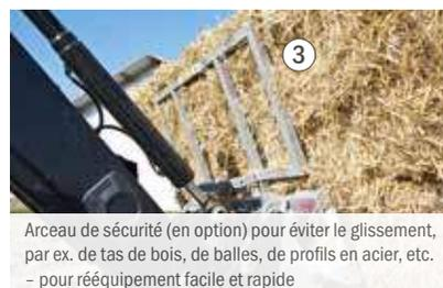
Arceau de sécurité (en option) pour éviter le glissement, par ex. de tas de bois, de balles, de profils en acier, etc. – pour rééquipement facile et rapide
