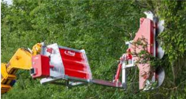
Montage à gauche sur chargeur télescopique
