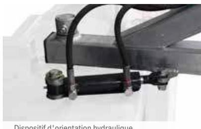
Dispositif d'orientation hydraulique
