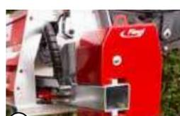
③ Contrepoids latéral – charge minimisée sur le bras oscillant du véhicule porteur.
