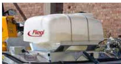
Réservoir 300 l pour le dispositif d'arrosage
