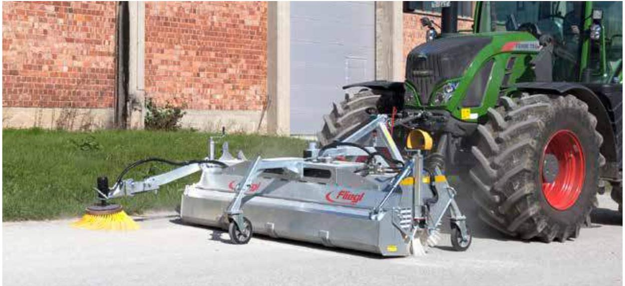
Avec attelage trois points, cuve de collecte des déchets hydraulique, balai latéral et roues porteuses
