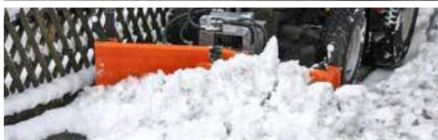
2 panneaux à orientation hydraulique avec commande séparée
