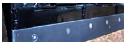
Geschoefde slijtstrip – geen uitstekende schroeven
