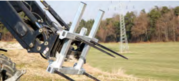
Uitvoering met verhoging met 4 rondebalentanden (2 tanden standaard)
