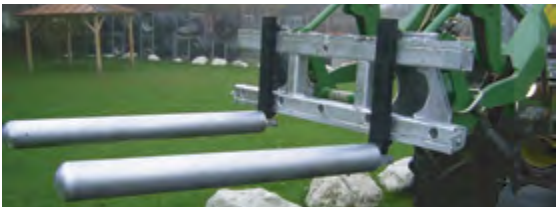
Opsteekbuizen voor rondebaletransport vastgezet met schroeven
