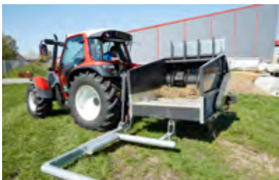
Hydraulische aanpassing van de van de opnamearm
