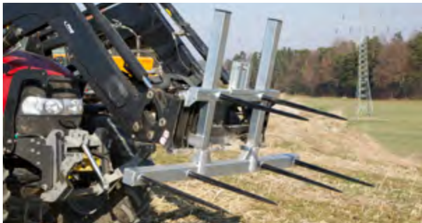
Versie met verhoging en 6 rondebalemtanden (4 tanden standaard)
