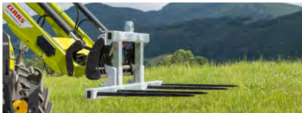
Standaarduitvoering met 4 rondebalemtanden (standaard)
