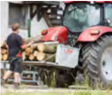
Uitklapbare pendelwand dient als bakverlenging
