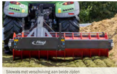
Silowals met verschuiving aan beide zijden
