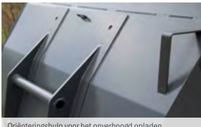
Oriënteringshulp voor het onverhoogd opladen van stortgoed
