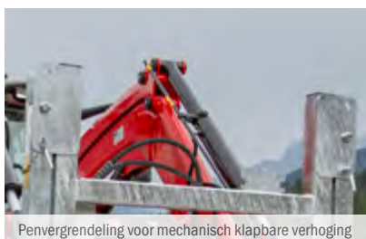
Penvergrendeling voor mechanisch klapbare verhoging
