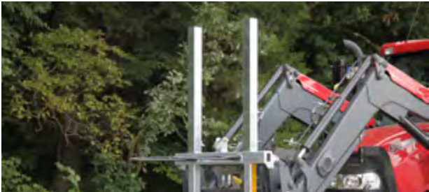
Opsteekbuizen voor balenvork »Combi« met verhoging
