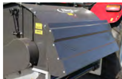
Hydraulisch dekseel – beste bescherming tegen verwondingen
