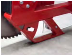
Beschermbeugel voorkomt bodemcontact van het onderste zaagblad.
