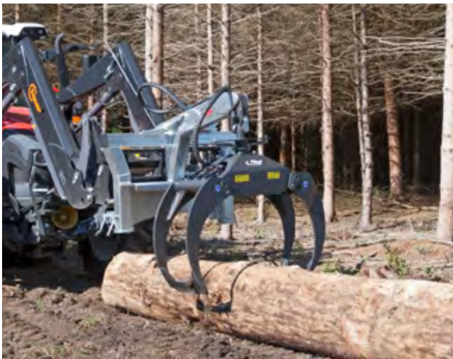
Hydraulische houtgrijper »RZ 185 Combi« met mechanisch draaischarnier
