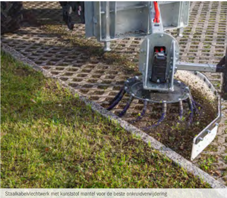
Staalkabelvlechtwerk met kunststof mantel voor de beste onkruidverwijdering
