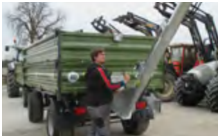
Eenvoudige verstelling van de verdeelhoek
