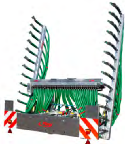
Transportbescherming met verlichting en waarschuwingsborden (standaard)
