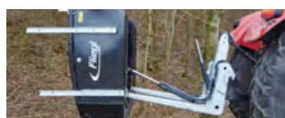
2 cilinders voor een optimale kantelhoek van 111°
