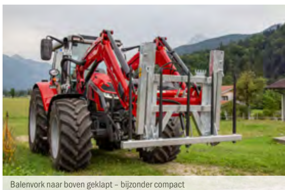
Balenvork naar boven geklapt – bijzonder compact
