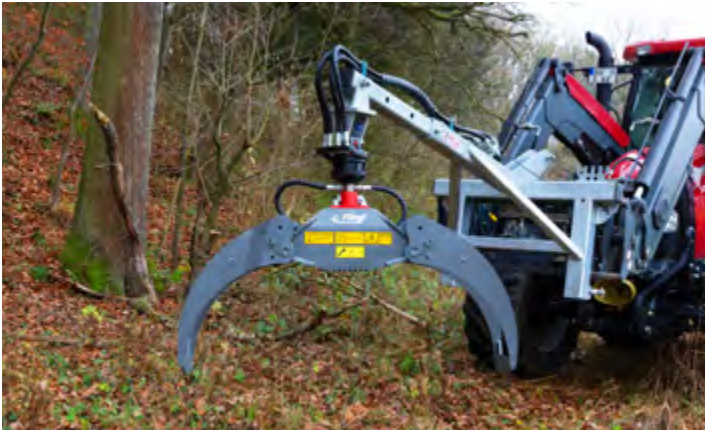
Overlaadgrijper met lasthaakverlenging, draaimotor, Euronorm- en driepuntsopname
