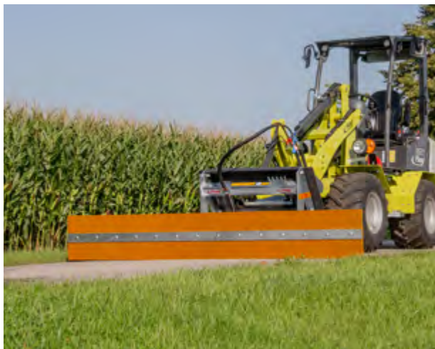
Afbeelding van rubberen strip met ingevulkaniseerde staaldraden (optioneel)
