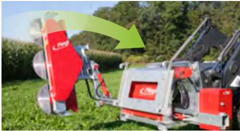
Snoeizaagkop voor aanbouw links en rechts zwenkbaar
