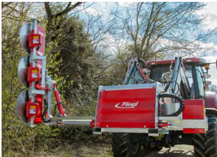
Vlakke, speciaal gevormde zaagkop voor het beste zicht – ideaal om struiken of grof kreupelhout te zagen
