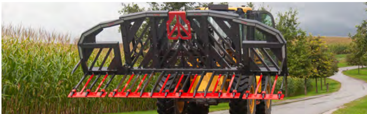
Afb. kuilvork »Heavy duty« met opzetsnijder voor maïssilage
