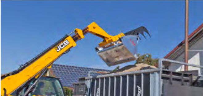
Tanden gemaakt van hoogwaardig slijtvast staal HB 500 (dikte 20 mm)
