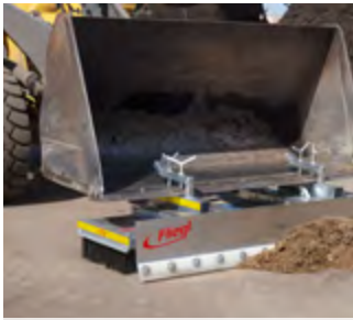
De »Löwe« met egaliseerblad (optioneel) – verwijdt zelf vastgereden verontreinigingen
