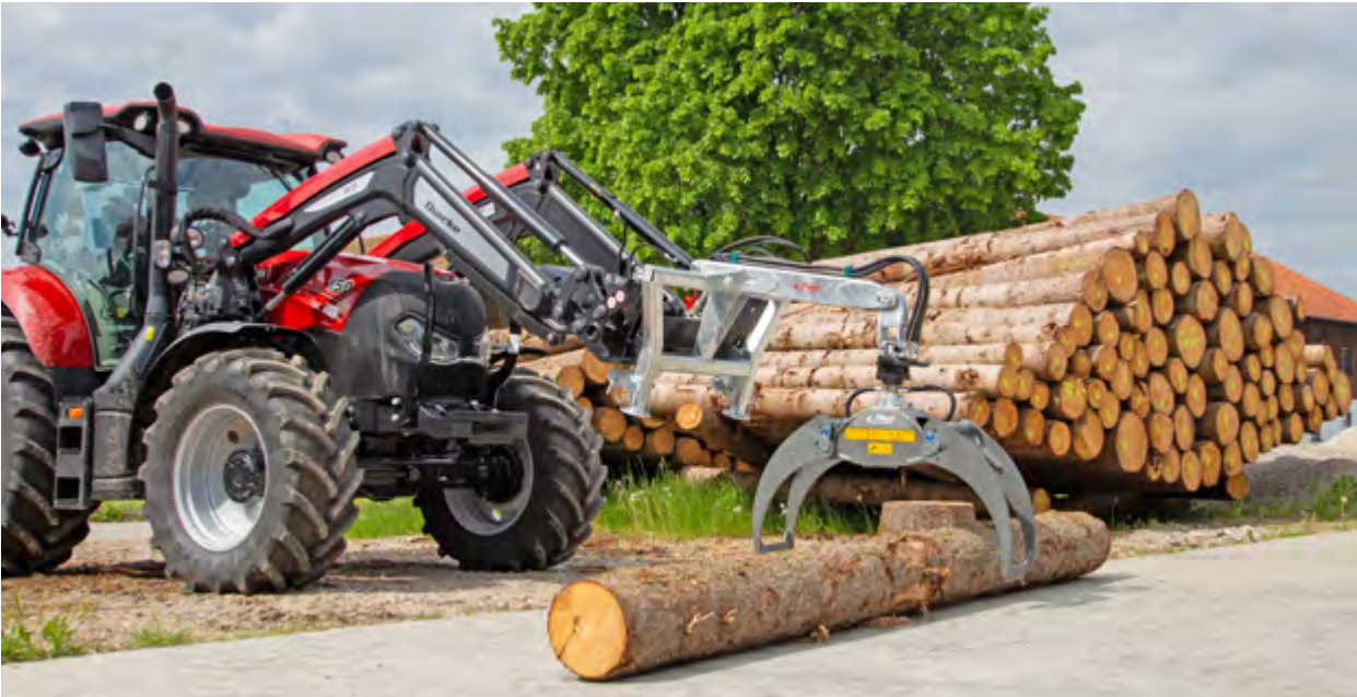
Overlaadgrijper met lasthaakverlenging, draaimotor, Euronorm- en driepuntsopname
