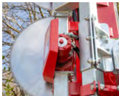
Aandrijving van de zaagbladen met oliemotoren
