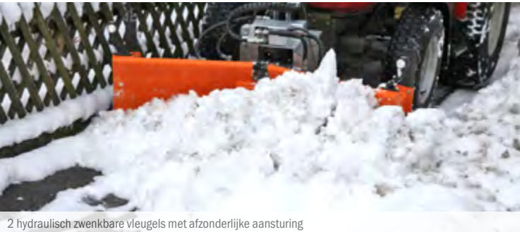
2 hydraulisch zwenkbare vleugels met afzonderlijke aansturing
