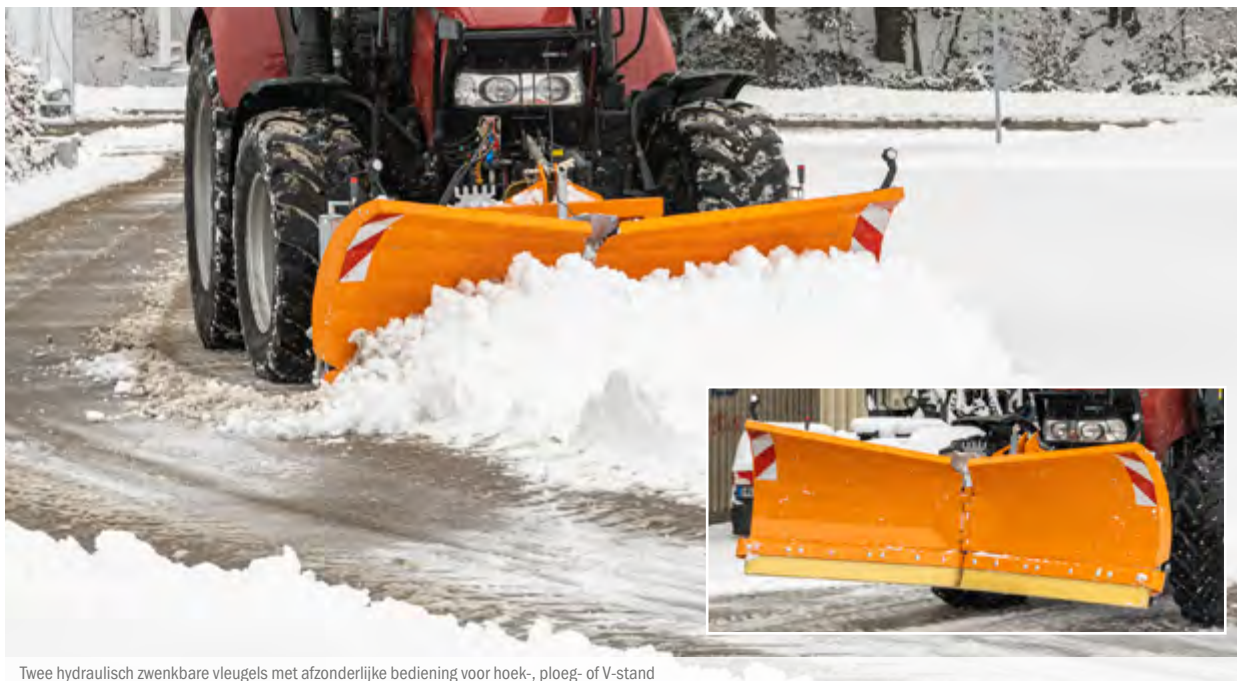
Twee hydraulisch zwenkbare vleugels met afzonderlijke bediening voor hoek-, ploeg- of V-stand
