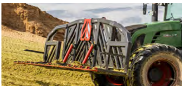
Afb. kuilvork »Heavy duty« met opzetsnijder voor maïssilage
