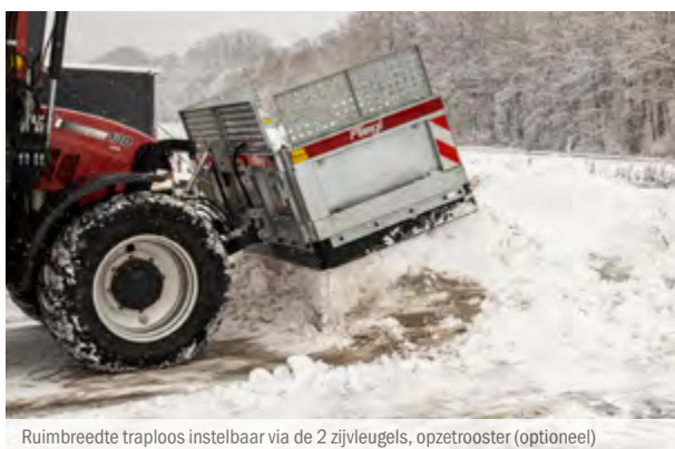
Ruimbreedte traploos instelbaar via de zijvleugels, opzetrooster (optioneel)
