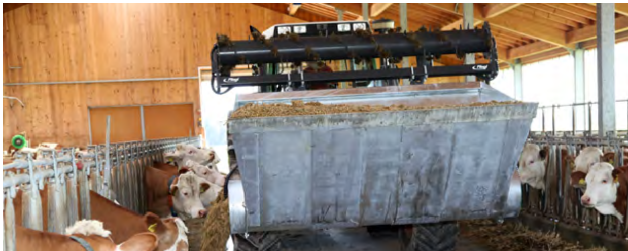
Voerverdeelbak, hier met freeswals (niet in leveringsomvang)
