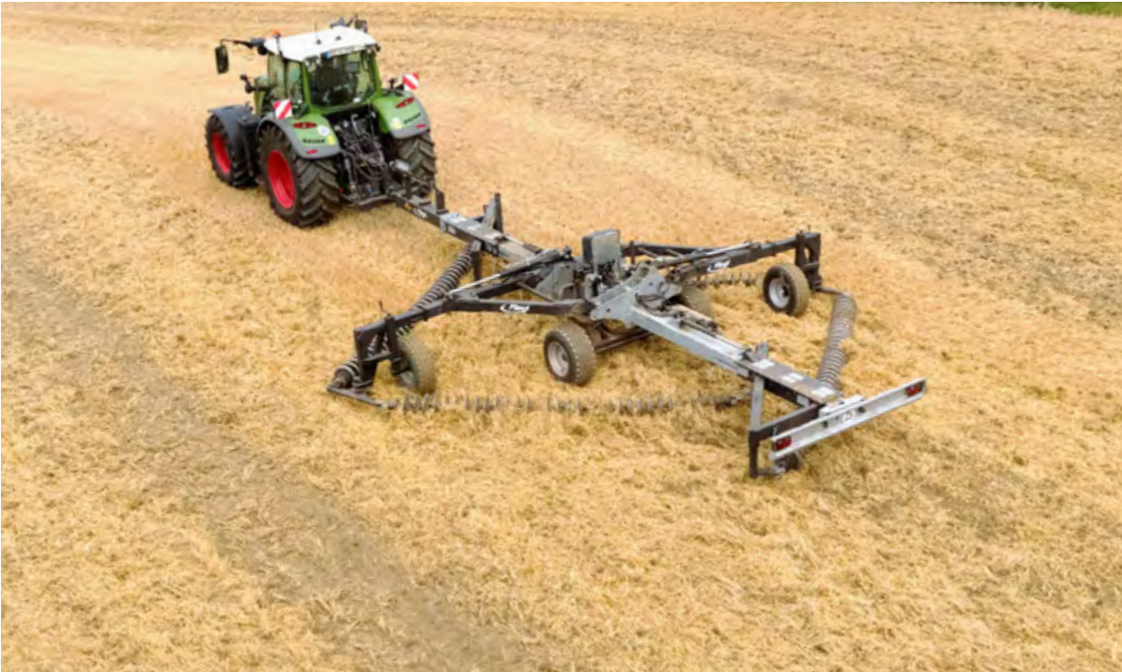
Zware kettingen met instelbare bewerkingsagressiviteit van 51° tot 58
