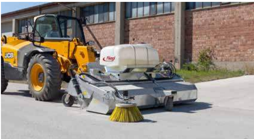
Traploos verstelbare veegwals – tot de uiterste slijtgrens te gebruiken
