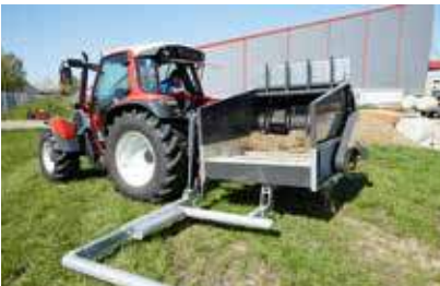
Hydraulische aanpassing van de van de opnamearm
