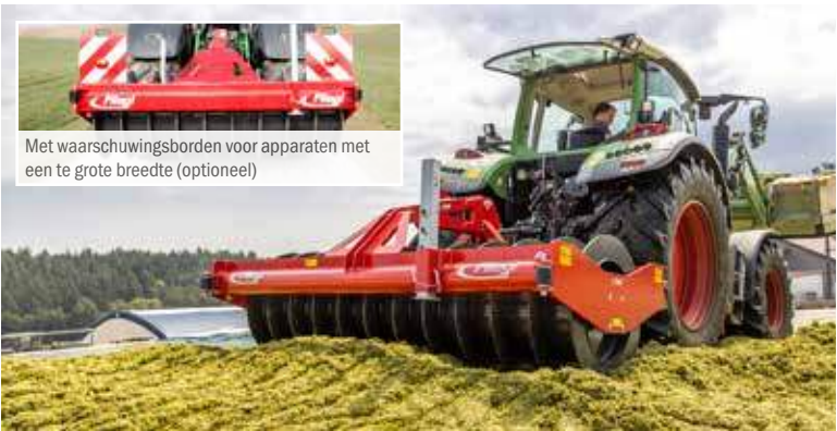
Silowals met verschuiving aan beide zijden
