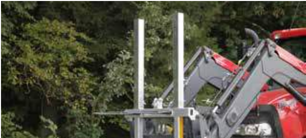
Opsteekbuizen voor balenvork »Combi« met verhoging
