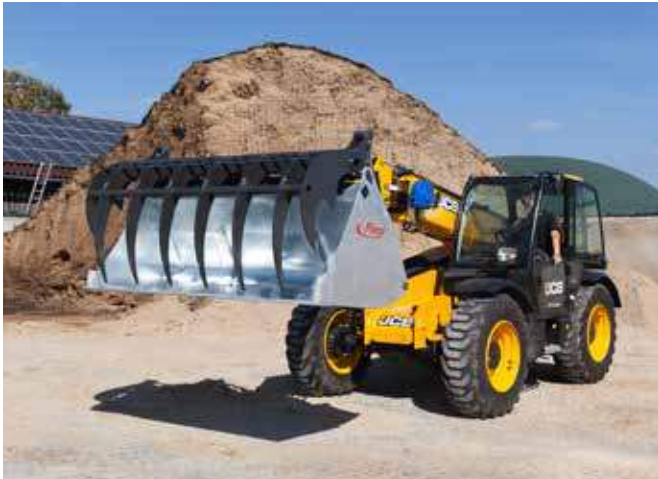
Tanden gemaakt van hoogwaardig slijtvast staal HB 500 (dikte 20 mm)
