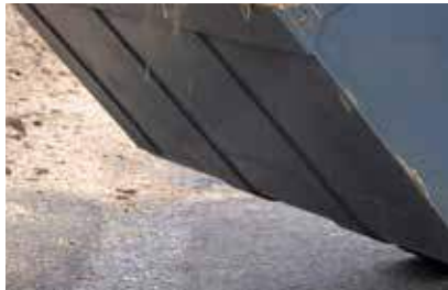
Verstevigingsplaten zorgen voor een stabiele onderbouw
