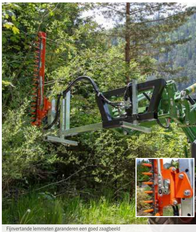
Fijnvertande lemmeten garanderen een goed zaagbeeld
