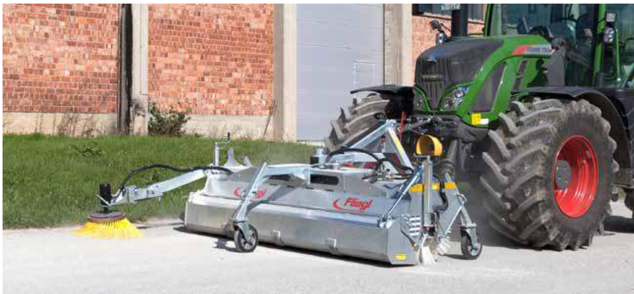
Met driepuntsopname, hydraulische vuilopvangbak, zijbezems en steunwielen
