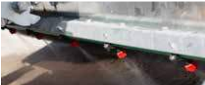
Sproeiapparaat – de beschermd op de behuizing aangebrachte sproeiers sproeien het water dicht bij de borstel en voorkomen stofvorming
