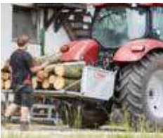
Uitklapbare pendelwand dient als bakverlenging
