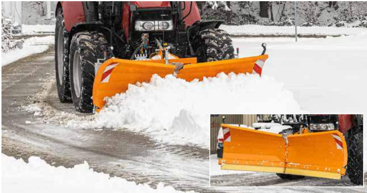
Twee hydraulisch zwenkbare vleugels met afzonderlijke bediening voor hoek-, ploeg- of V-stand
