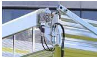
Hydraulische aandrijving via oliemotor - voor het oprollen van het net
