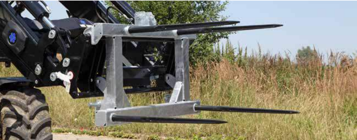
Standaarduitvoering, hier met 4 rondebalemtanden (2 tanden standaard)
