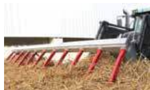
Conusbussen zijn al vastgelast in een robuuste tandendrager
