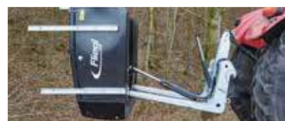
2 cilinders voor een optimale kantelhoek van 111°
