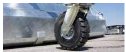
Heavy duty steunwielen Ø 306 mm – superelastische massief rubberen banden, breedte 105 mm, kogelgelagerd, slijtvast loopvlak, zwaar uitgevoerde draaikrans, verstelbare spindel
