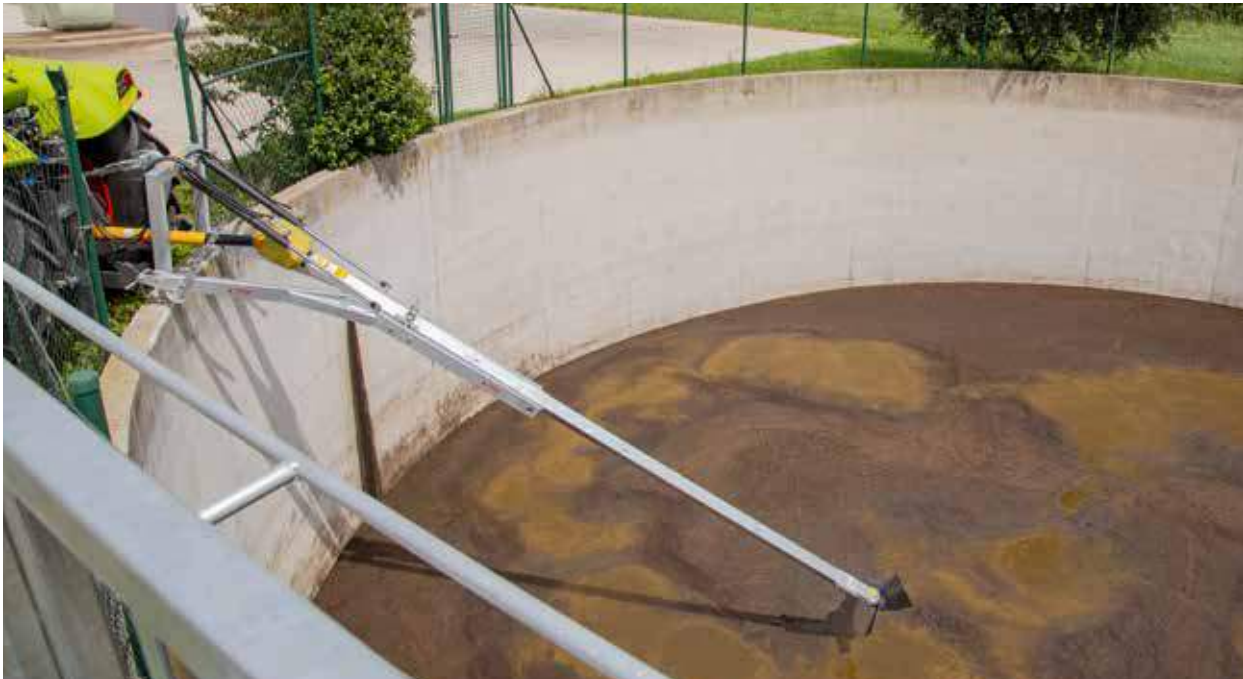
Hydraulisch opklapsysteem – kan worden gebruikt voor diepe putten
