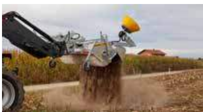
Met driepuntsopname, hydraulische vuilopvangbak, zijbezems en steunwielen
