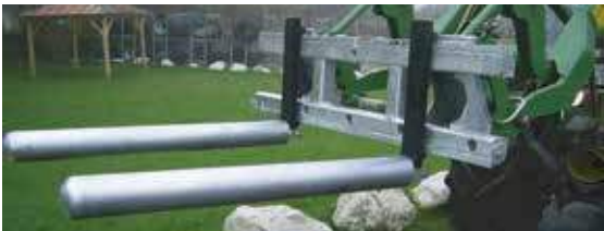
Opsteekbuizen voor rondebaletransport vastgezet met schroeven
