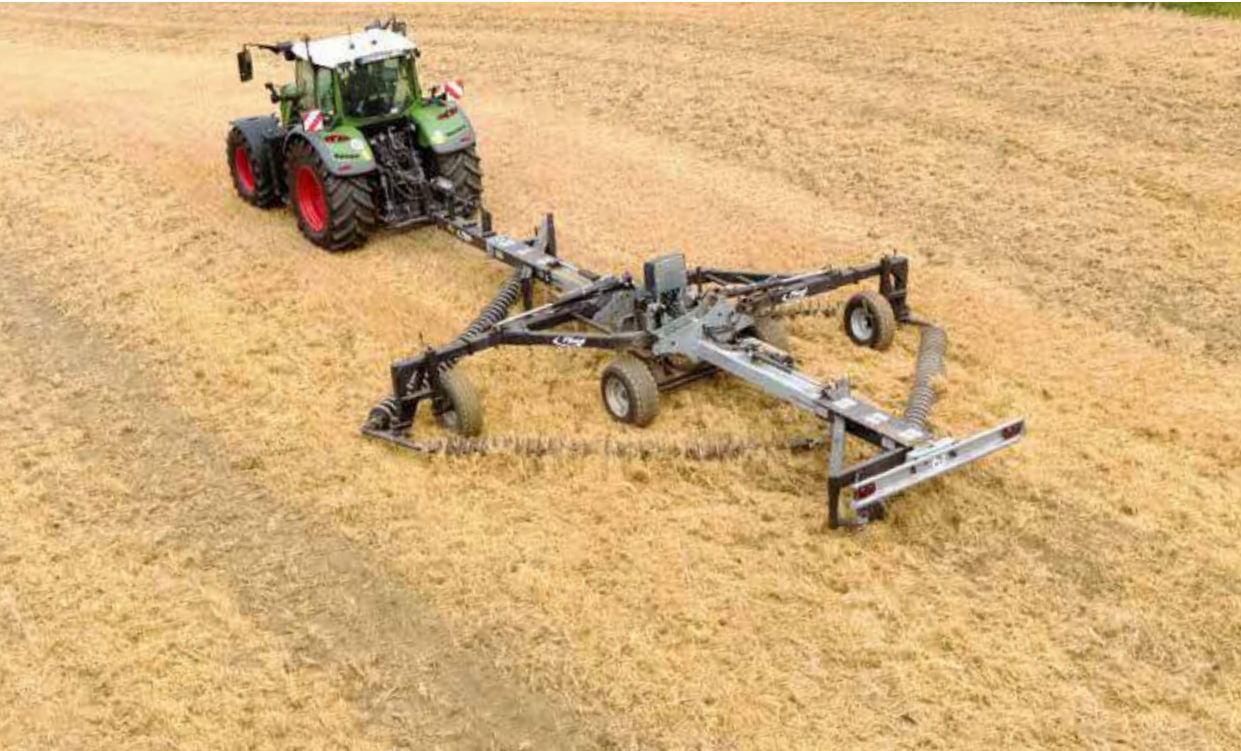
Zware kettingen met instelbare bewerkingsagressiviteit van 51° tot 58°
