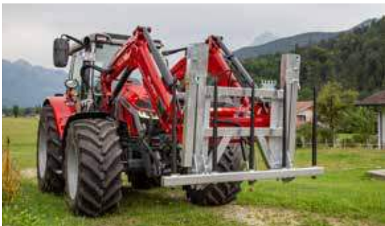
Balenvork naar boven geklapt – bijzonder compact
