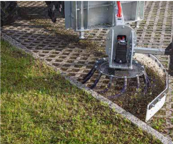
Staalkabelvechtwerk met kunststof mantel voor de beste onkruidverwijdering
