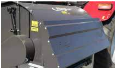
Hydraulisch deksel – beste bescherming tegen verwondingen
