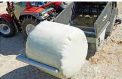
Hydraulisch verstelbare opnamearm
