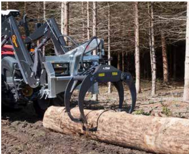
Hydraulische houtgrijper »RZ 185 Combi« met mechanisch draaischarnier
