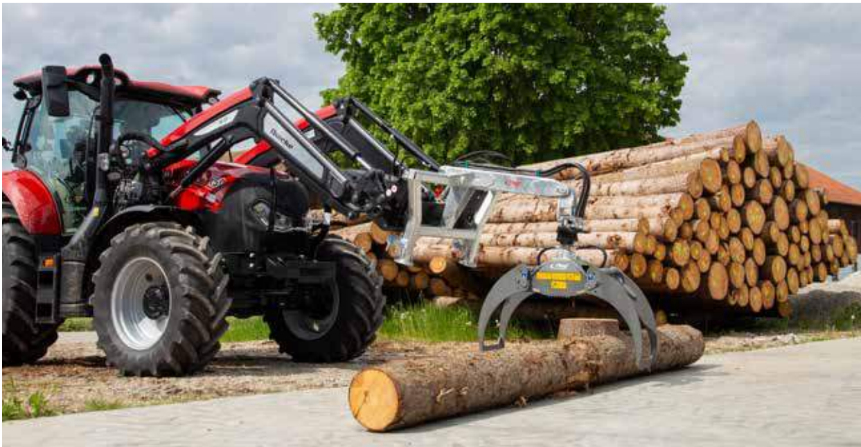
Overlaadgrijper met lasthaakverlenging, draaimotor, Euronorm- en driepuntsopname
