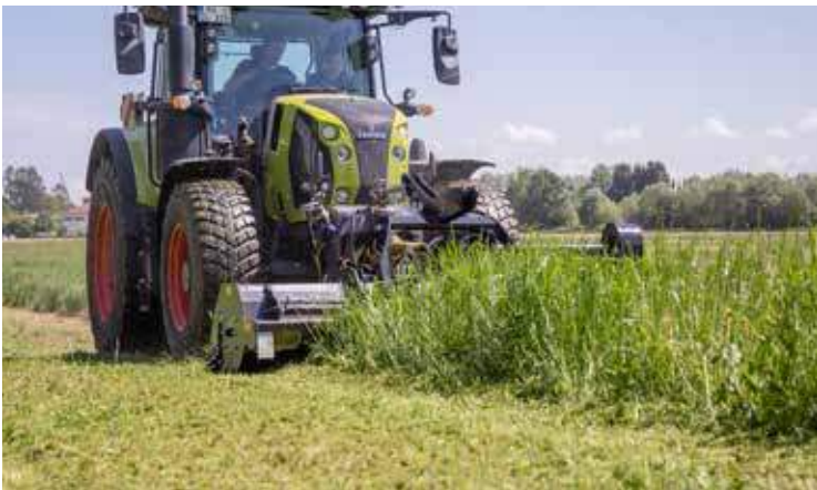
Instelbare klep voor goed neerleggen van de mulch
