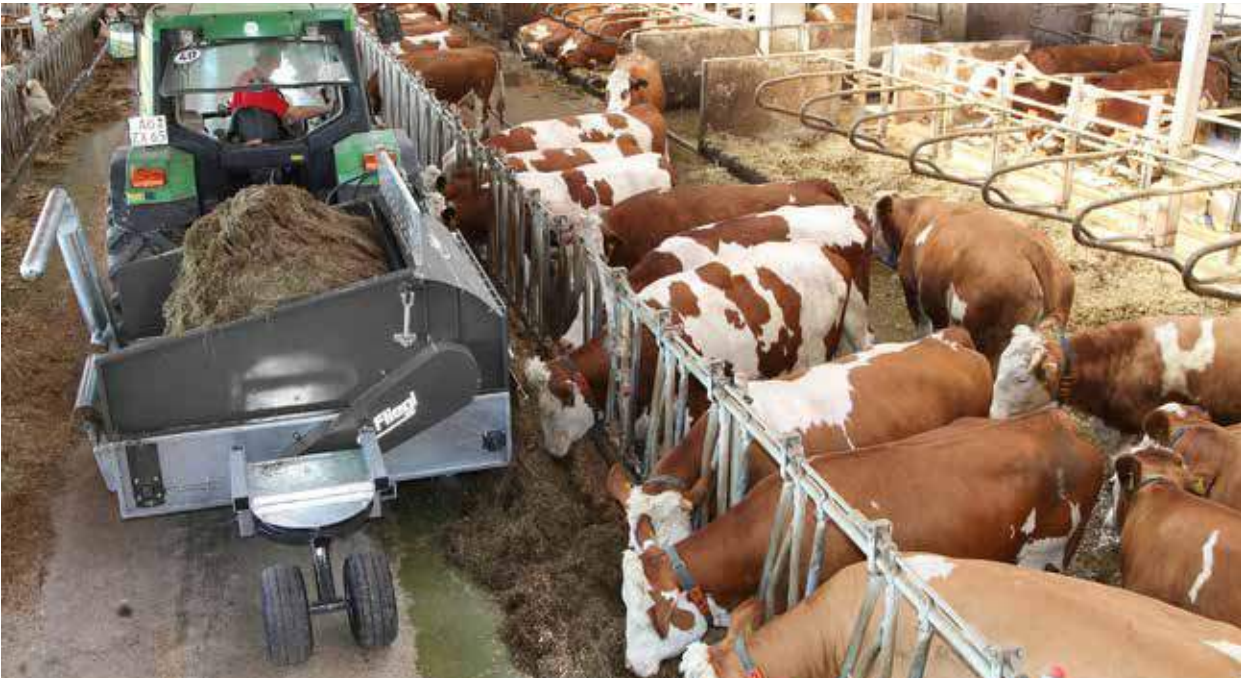
Met onderstel (optioneel) – optimale gewichtsverdeling en ontlasting van de hydraulische installatie van de tractor
