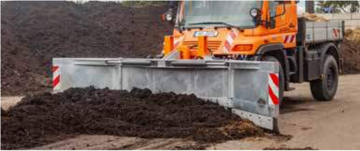
Met rubberstrips, duurzaam dankzij ingegoten staalkabels
