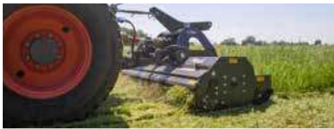
Instelbare klep voor goed neerleggen van de mulch
