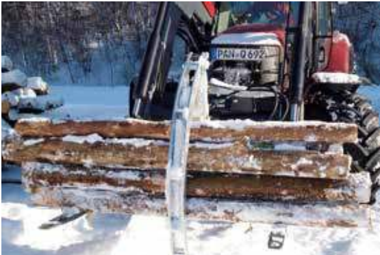
Hydraulische grijparm aan de combipalletvork »Freisicht« bevestigd
