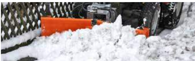
2 hydraulisch zwenkbare vleugels met afzonderlijke aansturing
