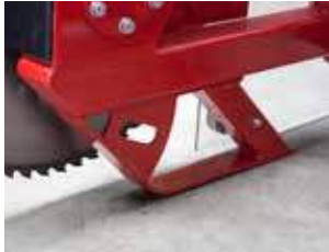
Beschermbeugel voorkomt bodemcontact van het onderste zaagblad.
