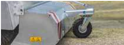
Heavy duty steunwielen Ø 306 mm – superelastische massief rubberen banden, breedte 105 mm, kogelgelagerd, slijtvast loopvlak, zwaar uitgevoerde draaikrans
