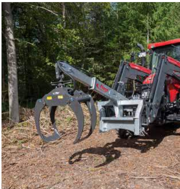
Hydraulische houtgrijper »LongNeck Combi« met mechanisch draaischarnier
