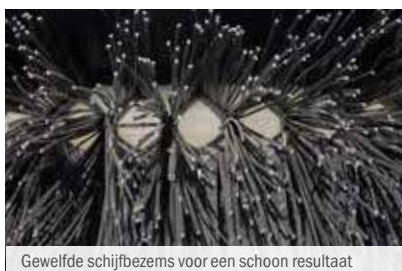
Gewelfde schijfbezems voor een schoon resultaat
