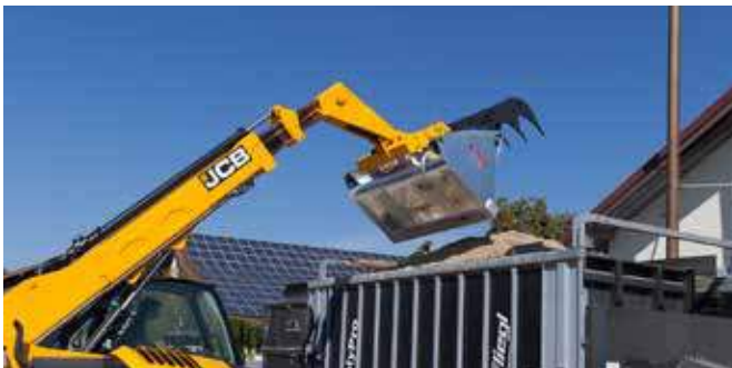
Tanden gemaakt van hoogwaardig slijtvast staal HB 500 (dikte 20 mm)
