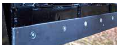
Geschroefde slijtstrip – geen uitstekende schroeven
