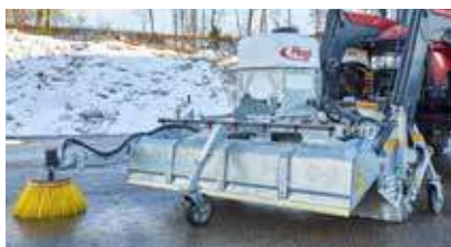
Met driepuntsopname, hydraulische vuilopvangbak, zijbezems en steunwielen
