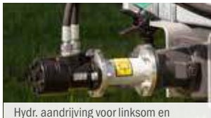
Hydr. aandrijving voor linksom en rechtsom draaien
