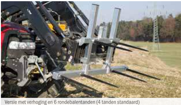
Versie met verhoging en 6 rondebalemtanden (4 tanden standaard)
