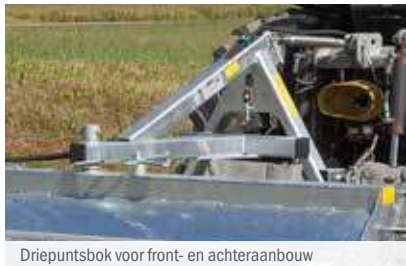
Driepuntsboks voor front- en achteraanbouw
