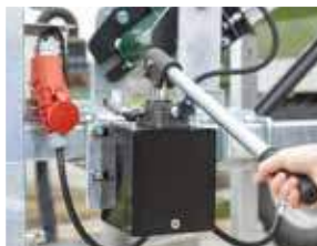
Handpomp voor hoogteverstelling van de transportband
