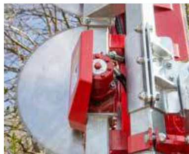
Aandrijving van de zaagbladen met oliemotoren
