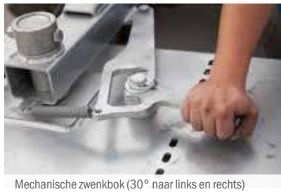
Mechanische zwenkbok (30° naar links en rechts)
