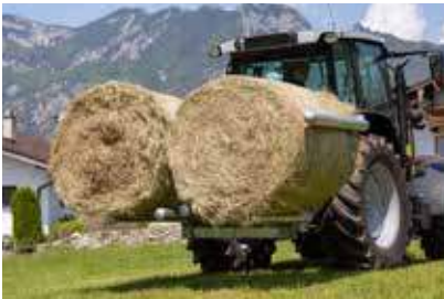
Werkbreedte 5-voudig verstelbaar met telkens 50 mm
