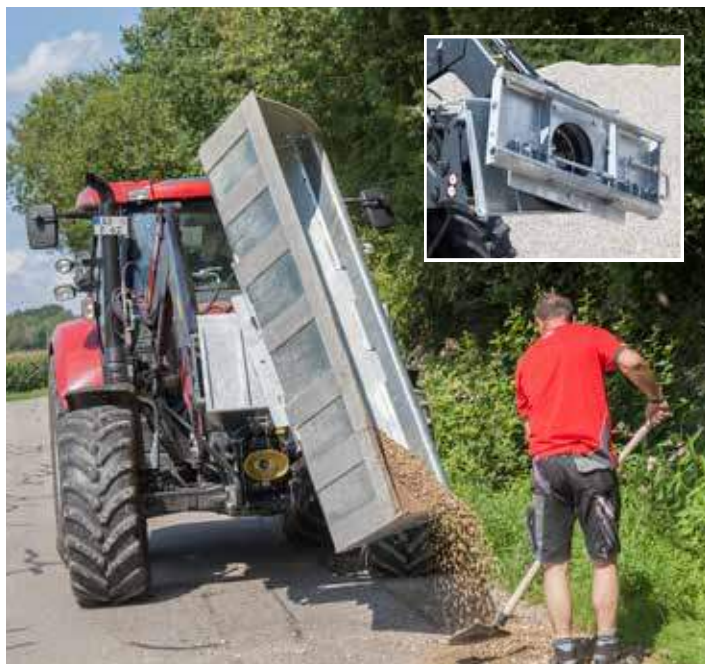
Met bak voor zwaar materiaal voor nauwkeurig legen van stortgoed (niet in leveringsomvang)
