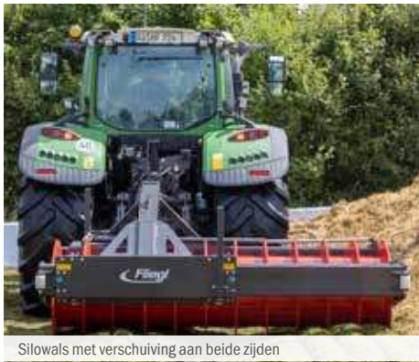
Silowals met verschuiving aan beide zijden
