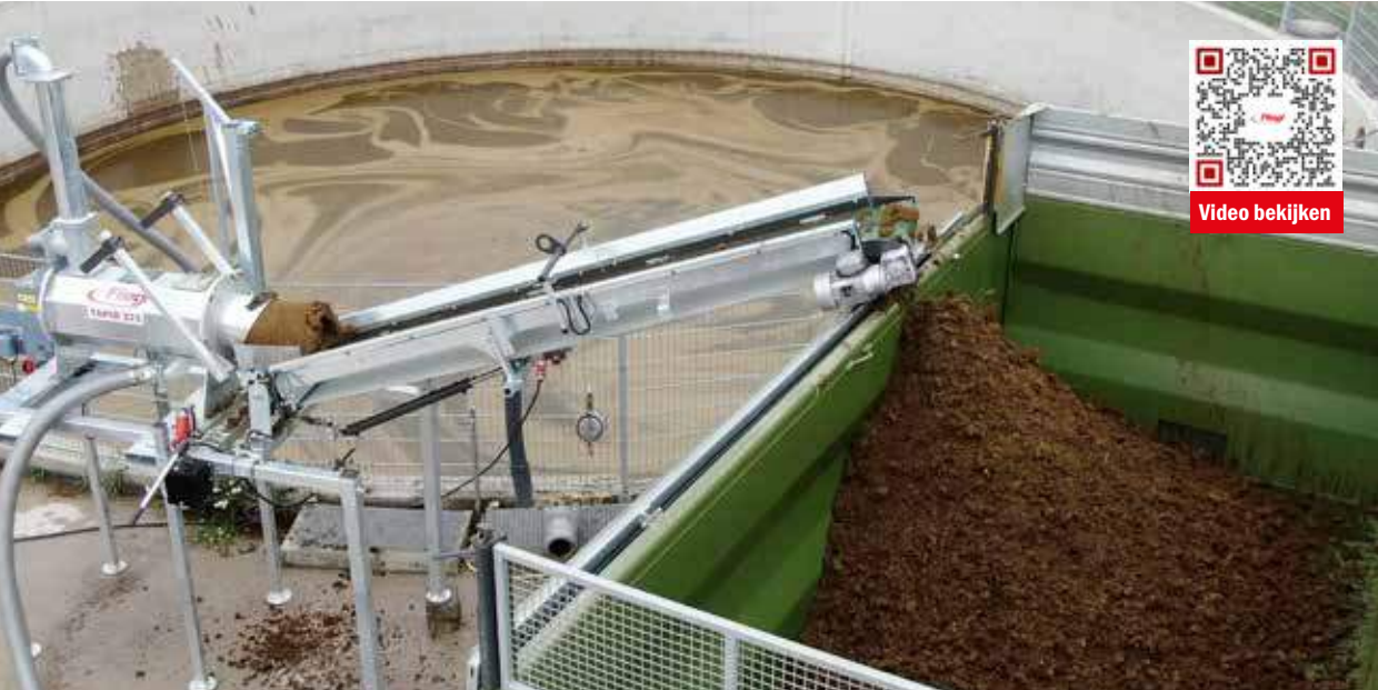
4 m lange transportband voor het laden van de vaste stoffen (optioneel)
