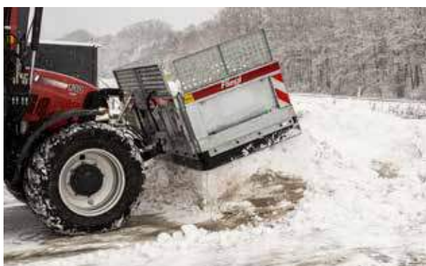
Ruimbreedte traploos instelbaar via de 2 zijvleugels, opzetrooster (optioneel)
