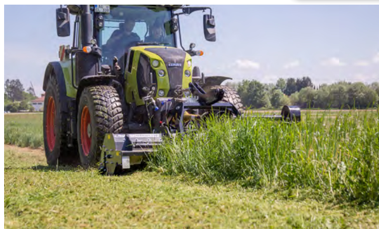
Instelbare klep voor het goed neerleggen van de mulch
