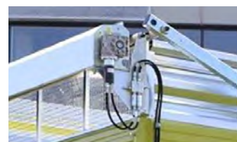
Hydraulisch aangedreven hydromotor voor het intrekken van het afdeknet
