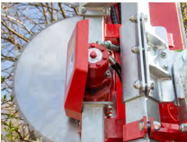
Aandrijving van de zaagbladen met oliemotoren
