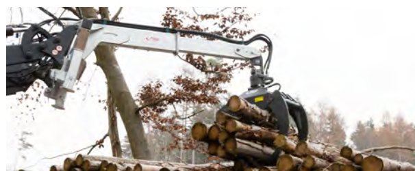
Hydraulische houtgrijper LongNeck Combi Plus met eindeloze rotatiemotor
