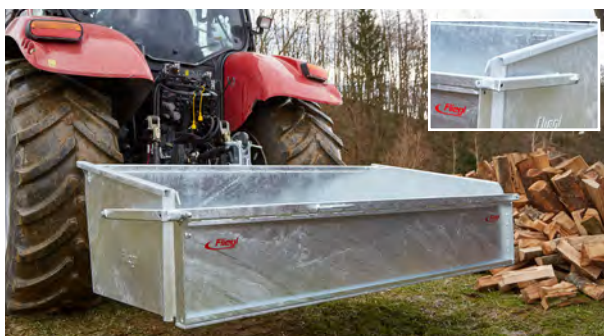
Bijzonder robuuste uitvoering door verstevigingen aan de kopse kanten van de achterbak
