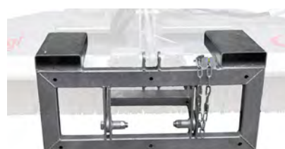
Stapelaaraanbouw met pendelstabilisator
