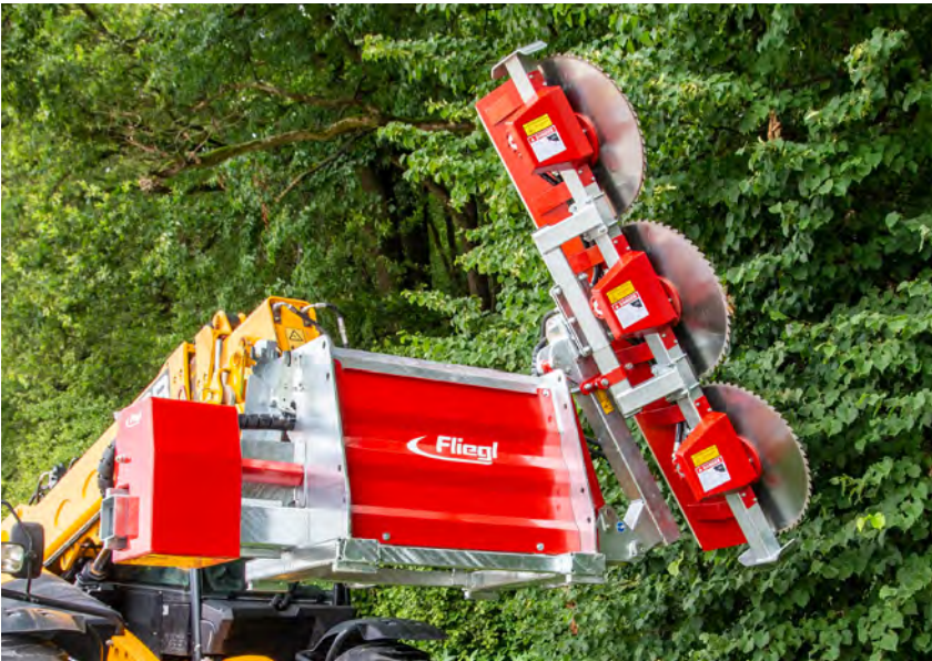
Vlakke, speciaal gevormde zaagkop voor het beste zicht: ideaal geschikt voor zagen van struiken of grof kreupelhout.
