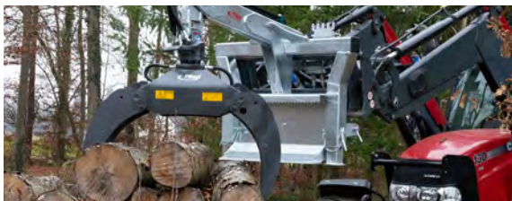
Hydraulische houtgrijper "Combi Plus RZ 185" met boomstammenblad
