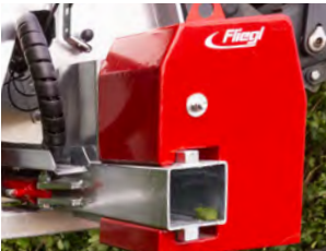
Zijdelings contragewicht - daardoor minimale belasting van de arm van het ondersteunende voertuig.
