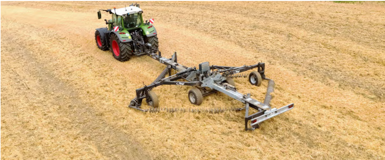
Zware kettingen met instelbare agressiviteit van de verwerking
