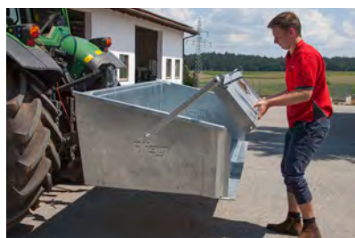
Bijzonder robuuste uitvoering door verstevigingen aan de kopse kanten van de achterbak
