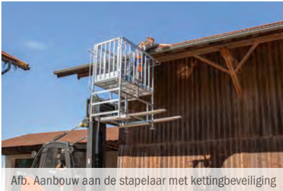
Afb. Aanbouw aan de stapelaar met kettingbeveiliging
