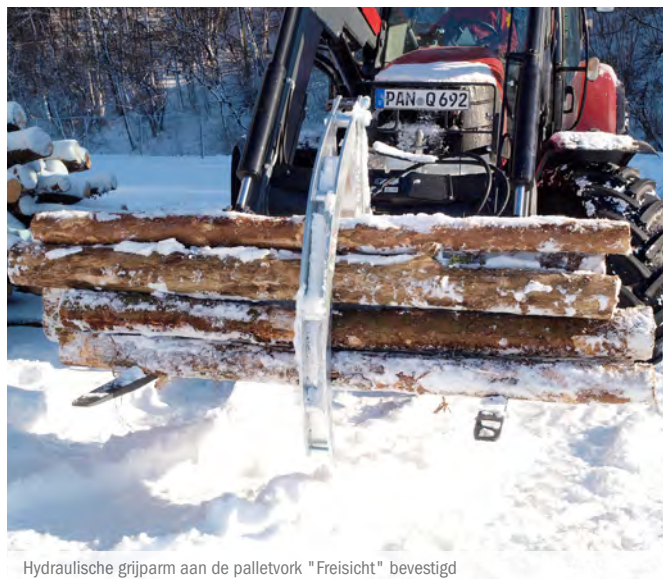
Hydraulische grijparm aan de palletvork "Freisicht" bevestigd
