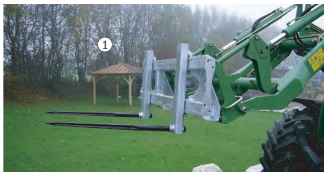
Verstelbare opname t.b.v. tanden voor ronde balen (tanden voor zware lasten; M28 x 1,5).
