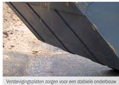
Verstevigingsplaten zorgen voor een stabiele onderbouw
