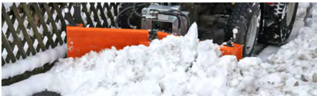
Vleugels separaat hydr. verstelbaar
