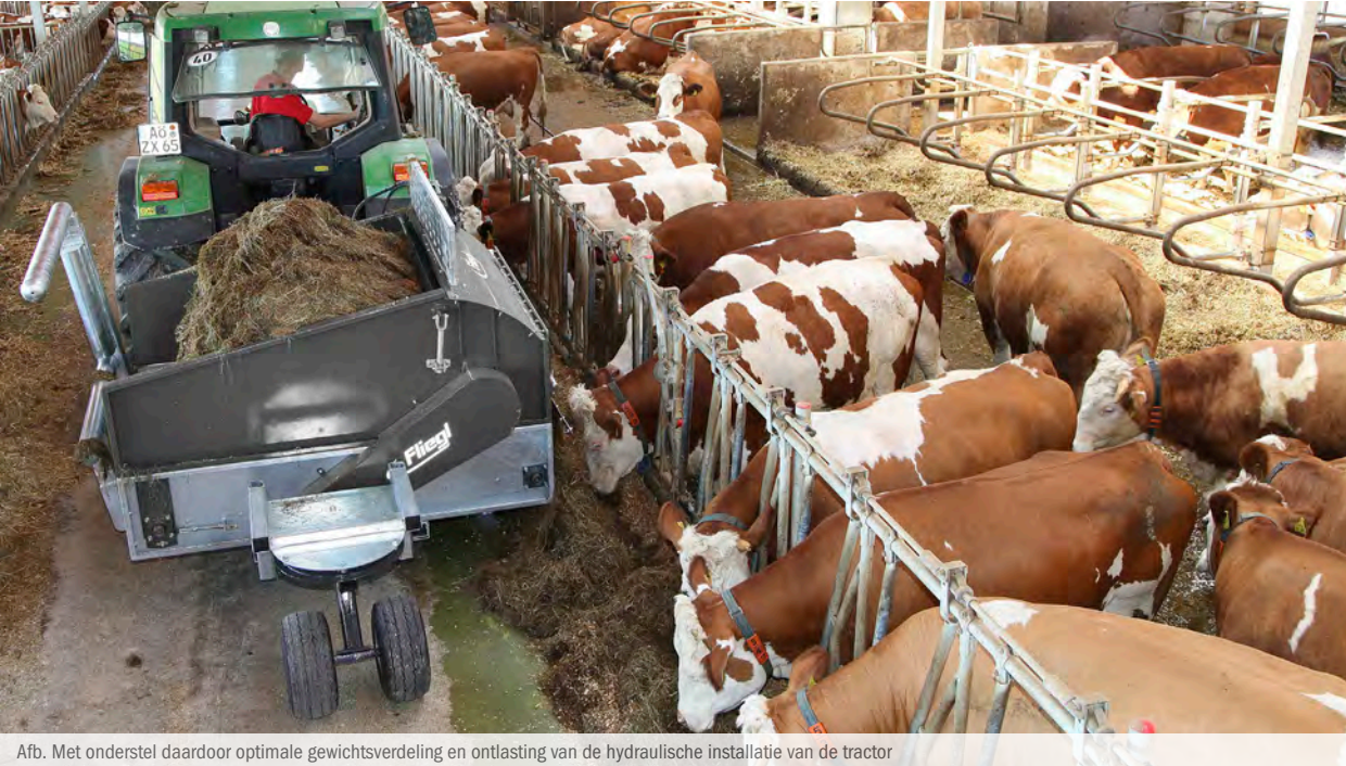
Afb. Met onderstel daardoor optimale gewichtsverdeling en ontlasting van de hydraulische installatie van de tractor
