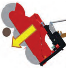
Aanwijzing: Snoei dikke takken altijd van boven naar onder om het klemmen van de zaagbladen te voorkomen!
