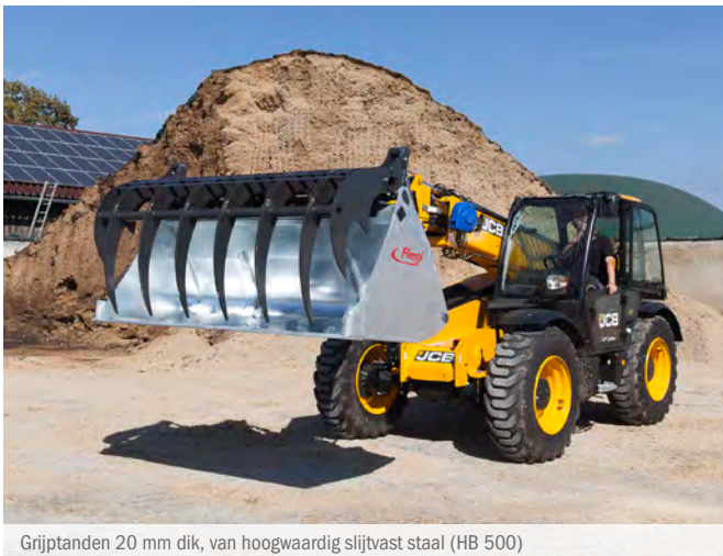
Grijptanden 20 mm dik, van hoogwaardig slijtvast staal (HB 500)
