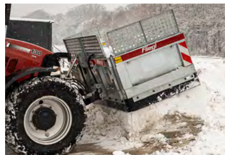
De ruimbreedte kan door de twee zijvleugels binnen het voorgeschreven bereik traploos worden versteld.
