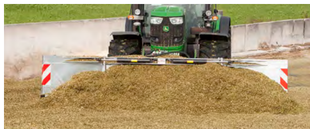
De ruimbreedte kan door de twee zijvleugels binnen het voorgeschreven bereik traploos worden versteld.
