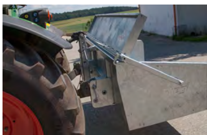
Bijzonder robuuste uitvoering door verstevigingen aan de kopse kanten van de achterbak
