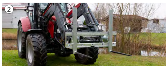
Verstelbare opname t.b.v. tanden voor ronde balen (tanden voor zware lasten; M28 x 1,5).
