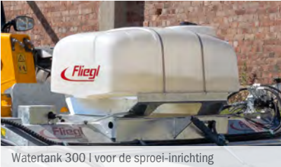
Watertank 300 l voor de sproei-inrichting
