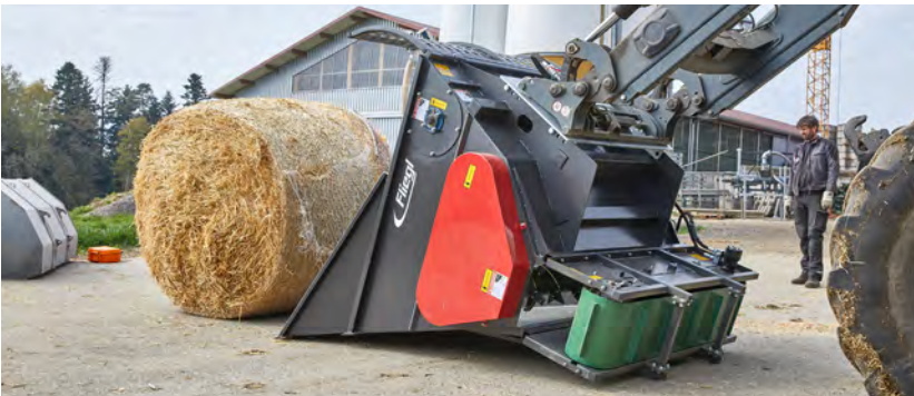
Afb. Baal wordt verwerkt zonder deze te delen
