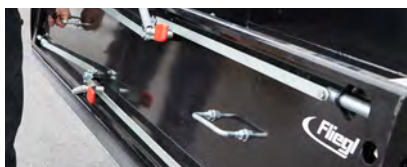
Snelle en eenvoudige vergrendeling van de klapwand
