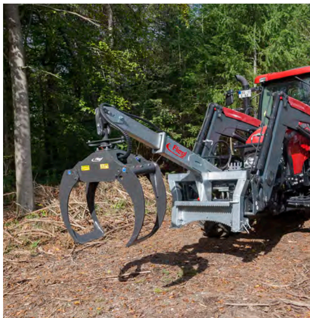
Hydraulische houtgrijper LongNeck Combi met mechanisch draaischarnier
