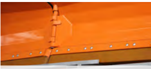
Enorm robuuste slijtstrip uit polyurethaan (200 x 40 mm)
