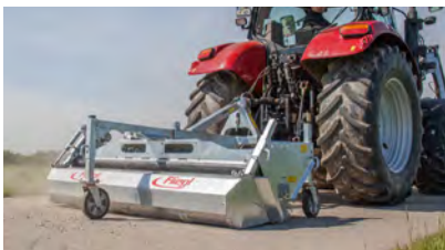
KEH type 500 met driepuntsopname, hydraulische vuilopvangbak, zijbezem en steunwiel voor
