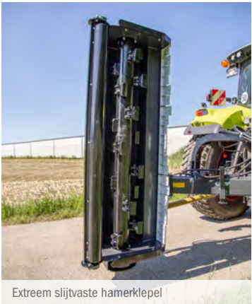
Extreem slijtvaste hamerklepel
