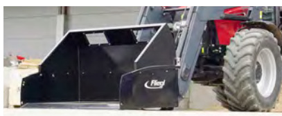
Opbouw met zichtuitsnede voor maximaal volume
