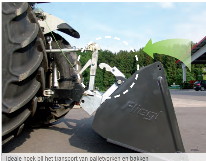
Ideale hoek bij het transport van palletvorken en bakken
