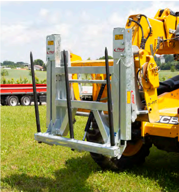
Afb. Ingeklapte balenvork zeer compact
