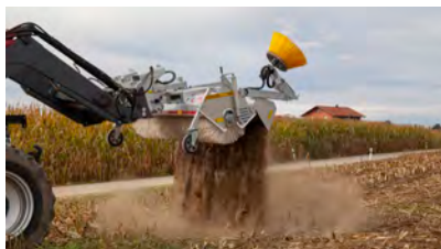
KEH type 500 met driepuntsopname, hydraulische vuilopvangbak, zijbezem en steunwiel voor
