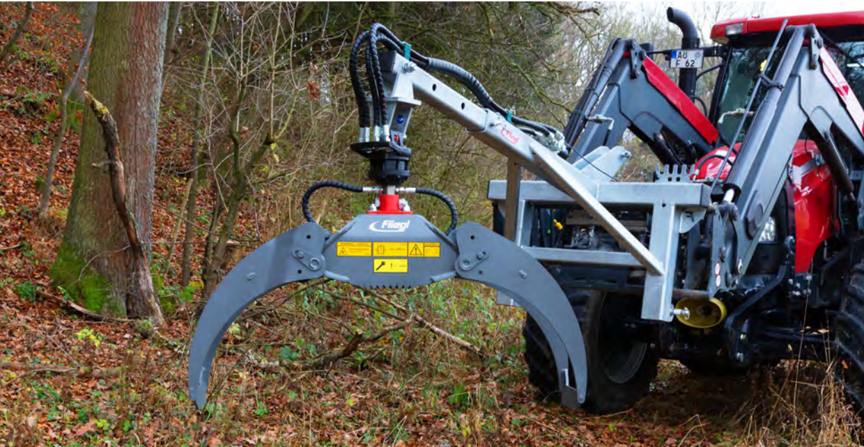
Overlaadgrijper met lashaakverlengstuk (Euro-driepuntsopname) & rotatiemotor
