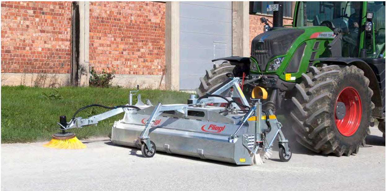
KEH type 500 met driepuntsopname, hydraulische vuilopvangbak, zijbezem en steunwiel voor
