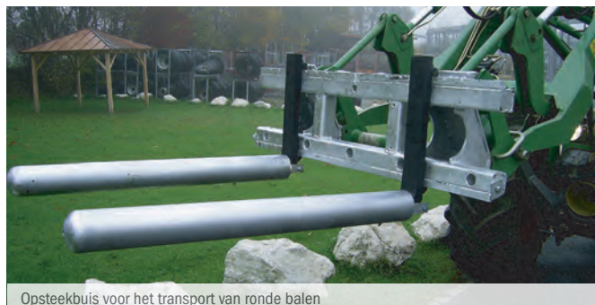
Opsteekbuis voor het transport van ronde balen
