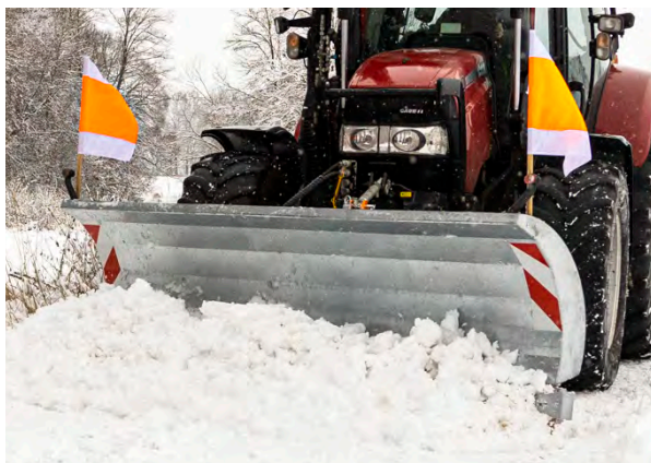
"Mammut Mono" verzinkt, bladhoogte: ca. 955 mm (waarschuingsvlaggen optioneel)
