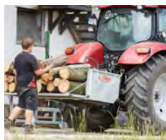
Uitklapbare pendelwand dient als bakverlenging
