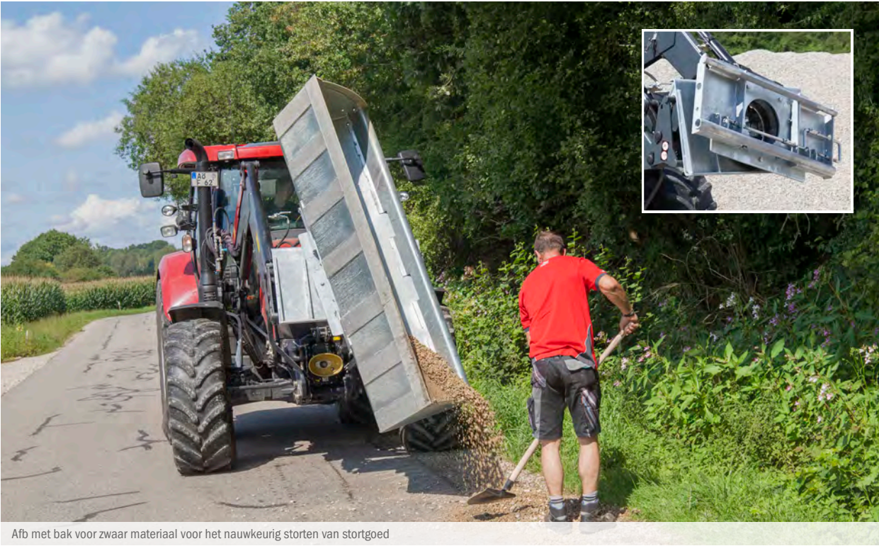
Afb met bak voor zwaar materiaal voor het nauwkeurig storten van stortgoed
