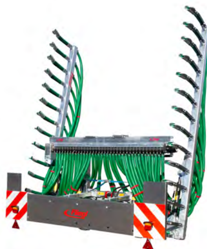
Afb. Transportbescherming met verlichting en waarschuwingsbord
