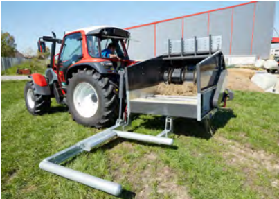
Afb. Met onderstel daardoor optimale gewichtsverdeling en ontlasting van de hydraulische installatie van de tractor
