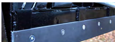
Geschoefde slijtstrip, geen uitstekende schroeven
