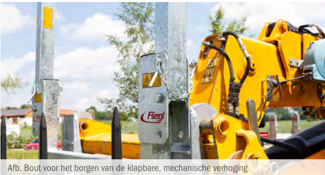
Afb. Bout voor het borgen van de klapbare, mechanische verhoging
