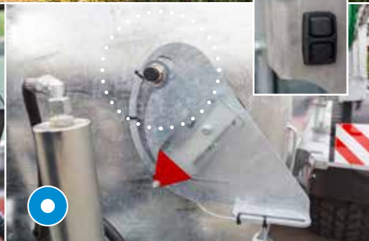
Sensor voor automatische pompomschakeling
