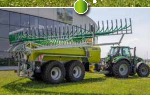
Geen geknikte uitloopslangen door speciaal opklapmechanisme
