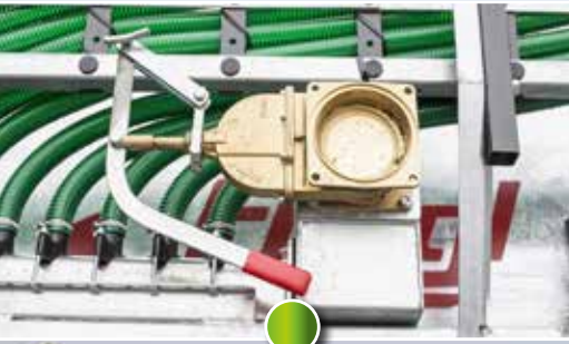
Mechanisch of hydraulisch openen van verzamelbak
