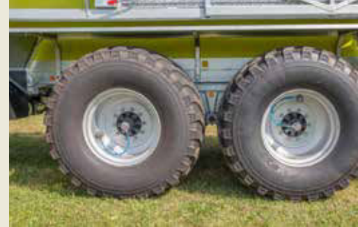
Bandenspanningssysteem voor inzet in het veld dat de bodem ontziet, met een twee leidingensysteem
