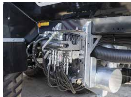
Stuurblok Load Sensing of constante stroom
