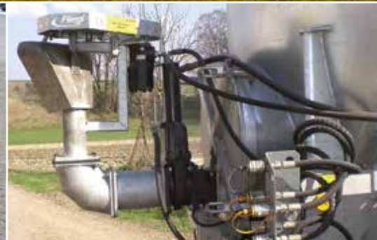
Hydraulische pendelasverspreider met een werkbreedte van 12 tot 18 m.
