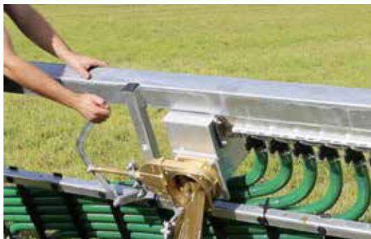
Verzamelbak (bij SKATE en GARANT) voor afwijkend materiaal, mechanische of hydraulische leging
