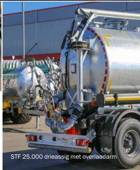
in pompuitvoering met Vogelsang draaizuigerpomp
