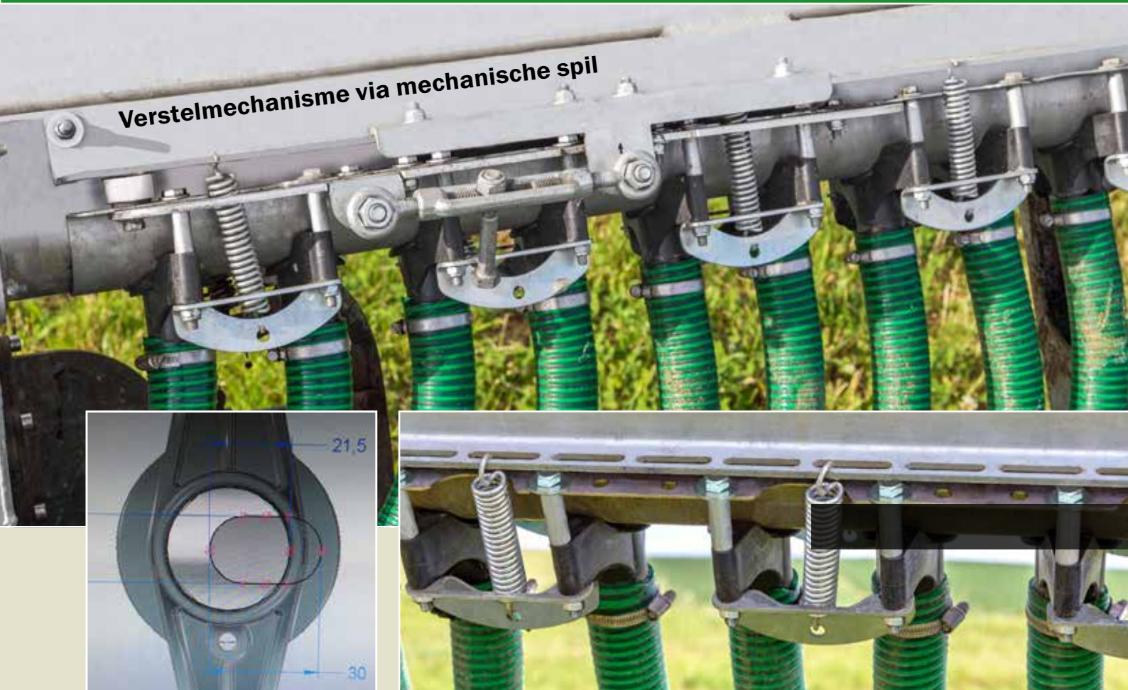
Veerspanstelsysteem van de schroefverspreider FlexFlow
