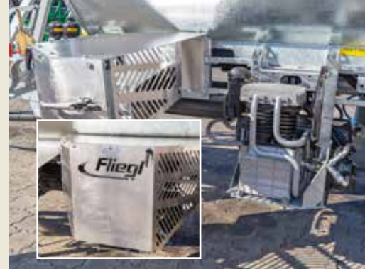
Zuigercompressor met tot 3,3 m 3 luchttopbrengst
