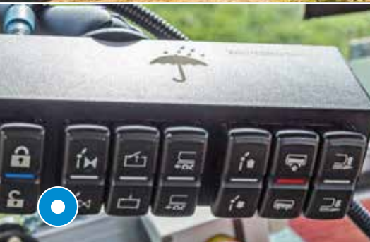
Bedieningspaneel voor tank + verspreider Afbeelding: rood knipperlicht dat de pomp tegen drooglopen beschermd
