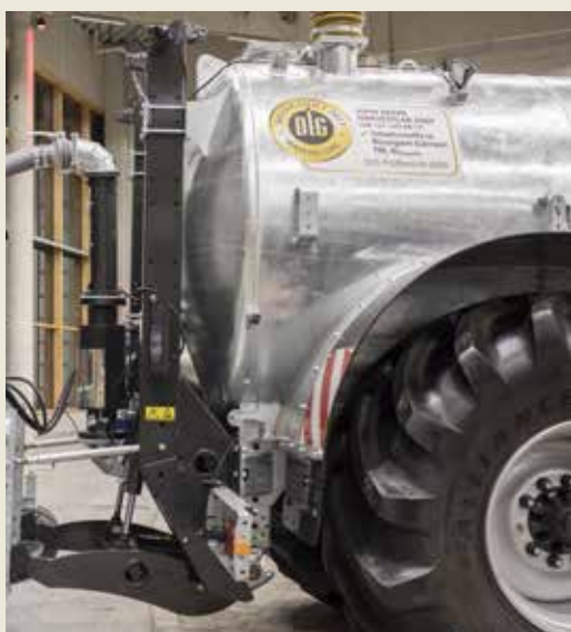
Vierpunthydrauliek met een hefkracht van 4.500 kg
