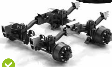
Asconstructie “Gigant Plus” bij MAXX Line Plus 16.000 l en 18.000 l
