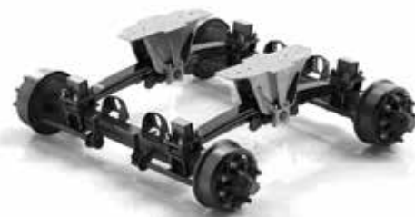
Titan tandemassige constructie voor optimale compensatie van bodemoneffenheden
