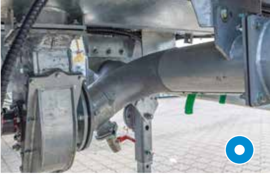
Bij vacuümtank: Turbovuller midden onder de tank
