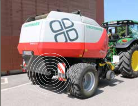
Voorbeeld van een bevestiging van een beacon aan een rondebalepers
