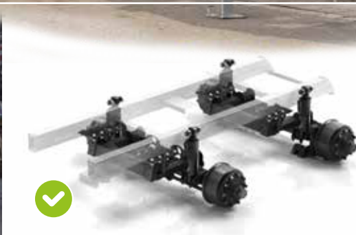
Asconstructie hydraulisch geveerd
