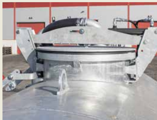
Hydraulische vulcoepel Maten: Ø 400 mm en Ø 600 mm Afhankelijk van montage naar links of rechts te openen
