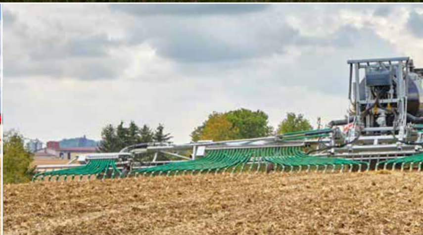
Fliegl SKATE 210 met pendelasframe voor verbeterde hellingcompensatie (alleen bij SKATE 210/240)
