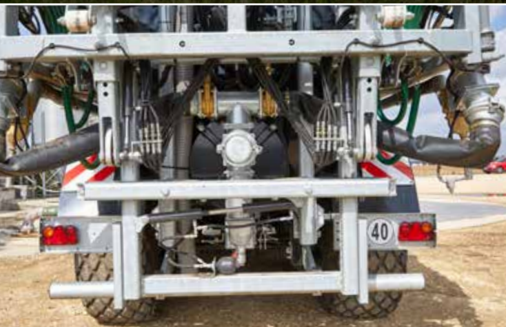
Fliegl SKATE 210 met pendelasframe voor verbeterde hellingcompensatie (alleen bij SKATE 210/240)
