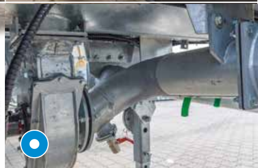
Hydraulische turbovuller is midden onder de tank geplaatst
